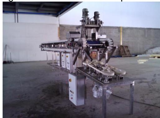
Figura 19. Cortadora de cabeza y cola junto a la cortadora de panza.
