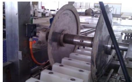
Figura 9. Ubicación de interruptores de seguridad en las cuchillas.
