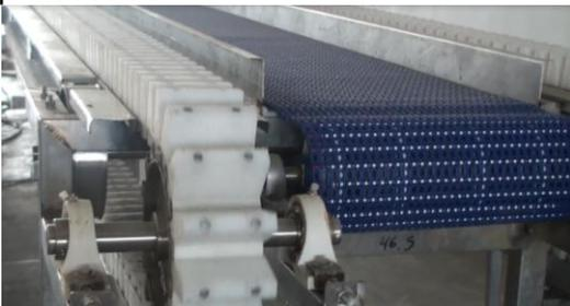
Figura 7. Banda central junto a banda de transporte de pescado.
