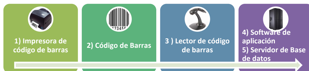
Figura 3.2.3: Funcionamiento del código de barras. Fuente: Elaboración propia en base a varios estudios existentes.
