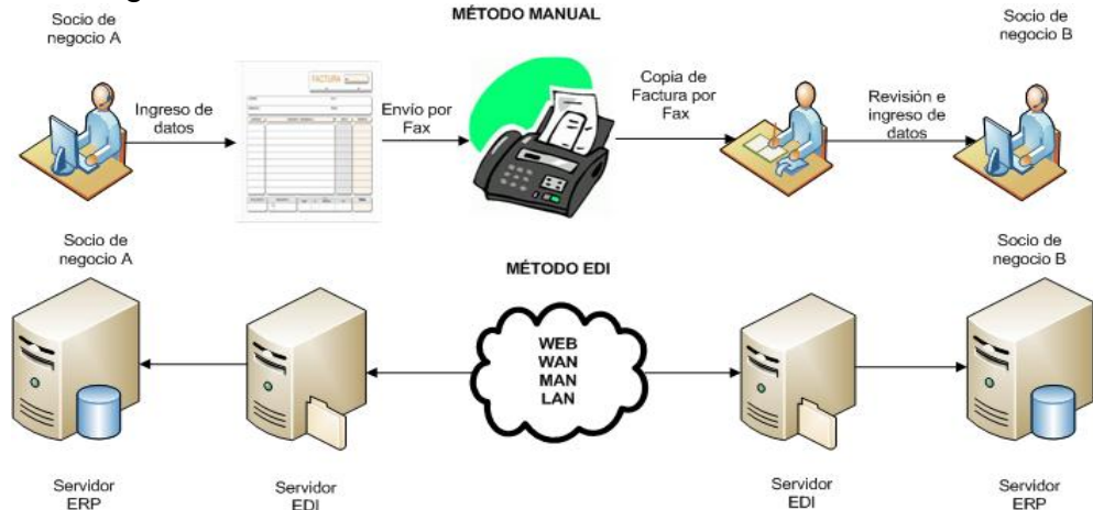
Figura 3.1.1: Funcionamiento Manual y Automatizado del EDI. Fuente: Elaboración propia en base a varios estudios existentes.
