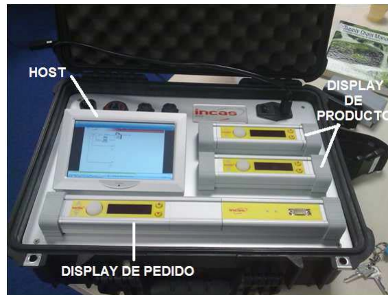
Figura 3.2.8: Componentes básicos de Pick to Light. Fuente: Empresa INCAS.
