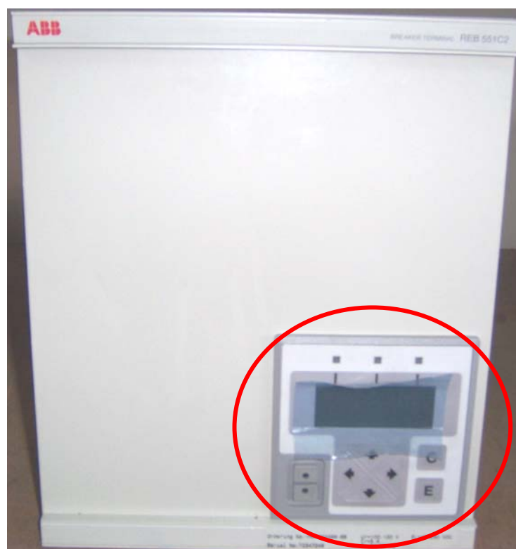
Figura. 2.17. IED adquirido por TRANSELECTRIC S.A. Módulo LED-HMI únicamente
