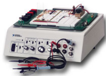
Figura. 3.1. Estación de trabajo de NI ELVIS
