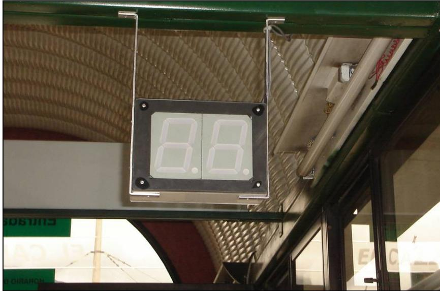
**Figura 5.14.** Fotografía del Módulo de Displays Instalado sobre la Segunda Puerta
