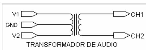
**Figura 5.11.** Acoplamiento entre el Módulo de Voz y el Amplificador de Audio
