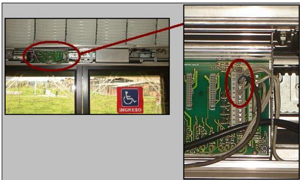
**Figura 5.7.** Señales del Sensor Ubicadas en el Controlador de una Puerta del Andén
