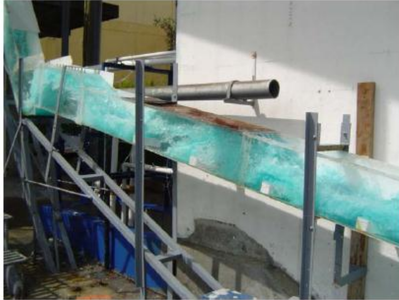
Fotografía 3.5: Canal de Pantallas Deflectoras con la transición, optimizado (sin las dos primeras pantallas y con la Tapa CPD).
