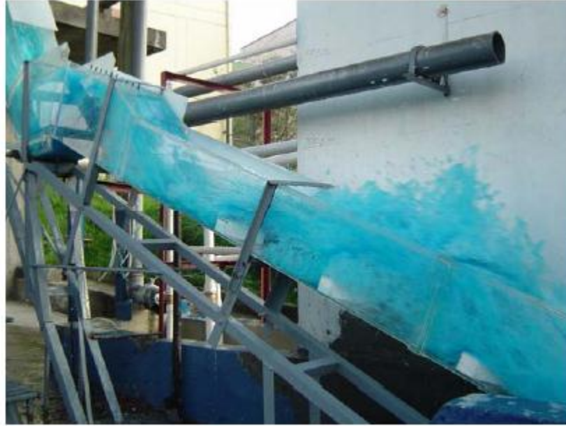
Fotografía 3.4: Funcionamiento del CPD con la transición, sin las dos primeras pantallas y sin la Tapa CPD.
