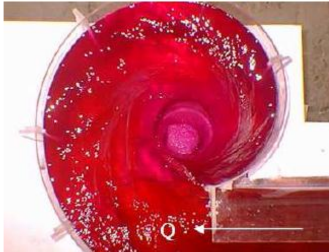
Fotografía 3.6: Vista superior de la cámara de entrada para flujo subcrítico.
