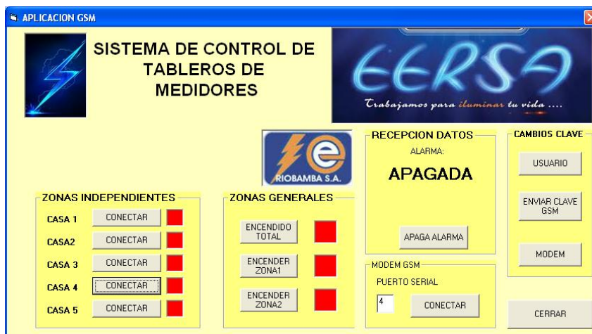
Figura 3.14 Todos los relés activados en Visual Basic
