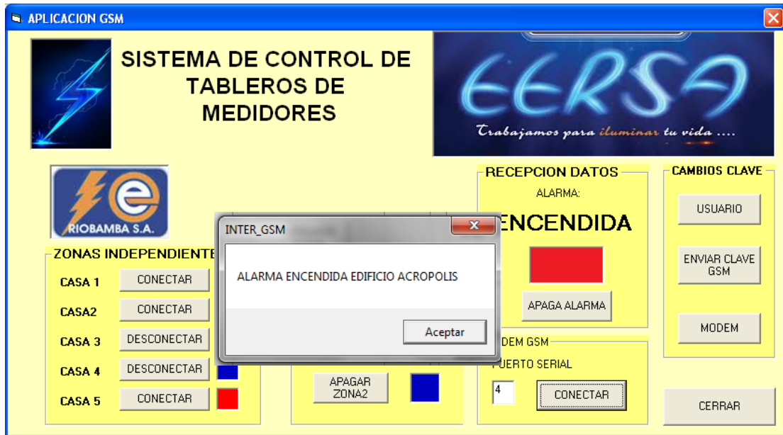
Figura 2.37 Mensaje de notificación de alarma encendida
