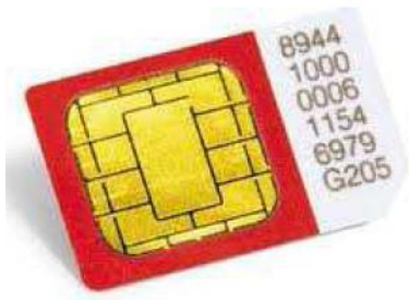
Figura 1.24 Tarjeta SIM. Tamaño 25x15x0.76 mm
