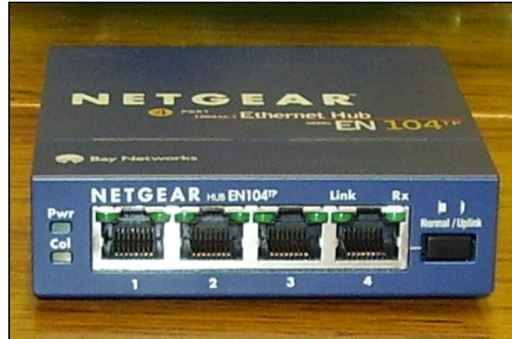
Figura. 2.3 Hub de 4 puertos Ethernet [6].
