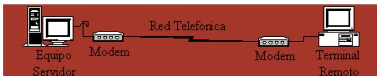
Figura. 4.1. Diagrama para la Comunicación entre Ordenadores
