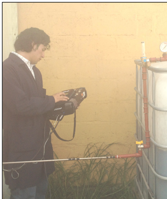
Figura 3.15 Análisis de Biogas in situ , con el equipo TESTO 350xl
