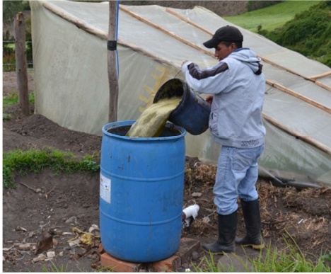
Figura 3.9. Fotografía de carga regular al digestor. Julio 2012. Elaborado por (Autor).
