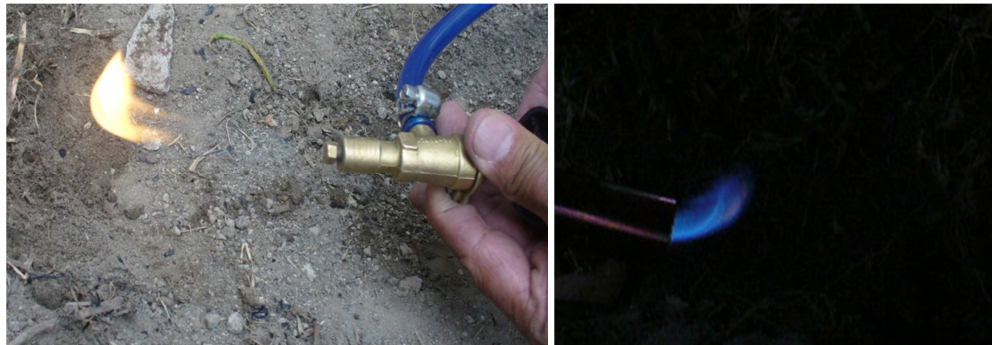
Figura 3.22. Gas metano encendido.
