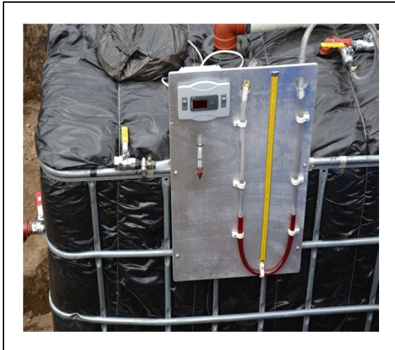
Figura 3.6. Fotografía de la termocupla y termómetro ambiental. Elaborado por: (Autor).
