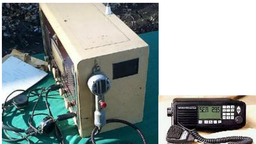
Figura I-2: Izq. Teléfono de radio para barco 1937, Der. Teléfono de radio para barco actual.
