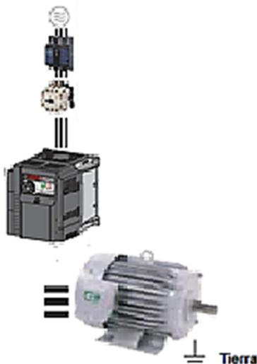
**Figura 5.2. Alimentación y Conexión del Variador FR-D720.**
