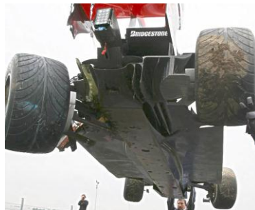
Gráfico 2.38.- Piso de un monoplaza F1
