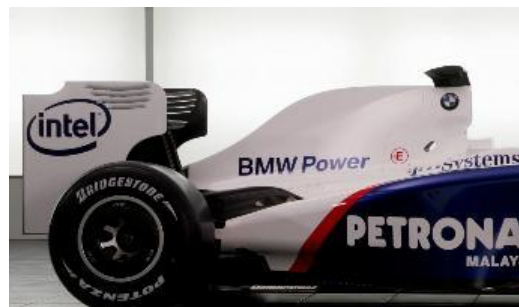
Gráfico 2.37.- Capot en un monoplaza F1
