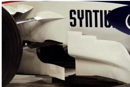
Gráfico 2.28.- Deflector lateral en un monoplaza de la F1
