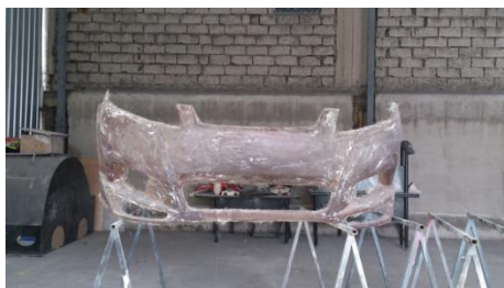
Figura 10. Fibra de vidrio Faldón delantero
