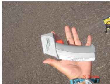
Gráfico 3.13.- Medidor de temperatura a laser raytek Fuente: fotografías propias
