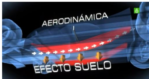
Figura 6. Efecto Suelo en un F1
