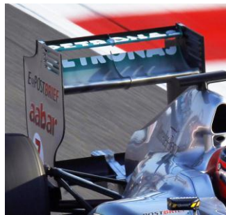
Gráfico 2.23.- Regulación automatizada de los alerones
