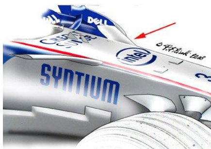
Gráfico 2.34.- Winglets en el borde superior del chasis
