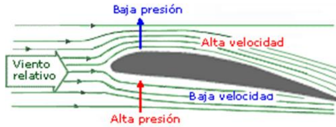
Gráfico 1.4.- Perfil alar velocidad-presión
