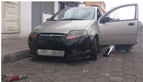
Figura 14. Instalación Estribos Laterales
