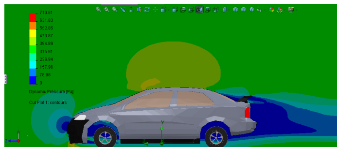
Gráfico 3.35.- Presión dinámica vista lateral (vehículo modificado)
