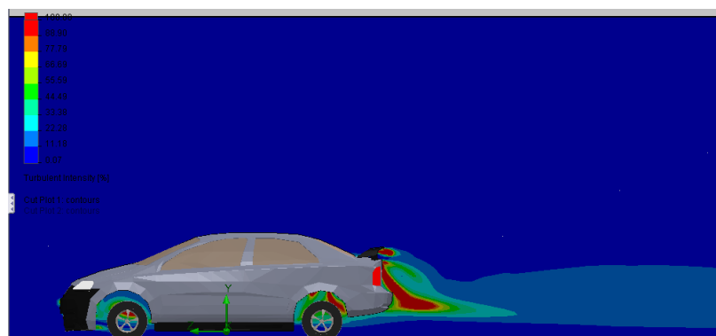
Gráfico 3.43.- Turbulencia vista lateral (vehículo modificado)
