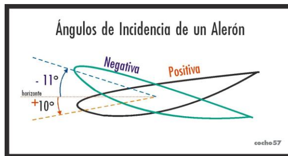
Gráfico 2.20.- Ángulos de incidencia de un alerón
