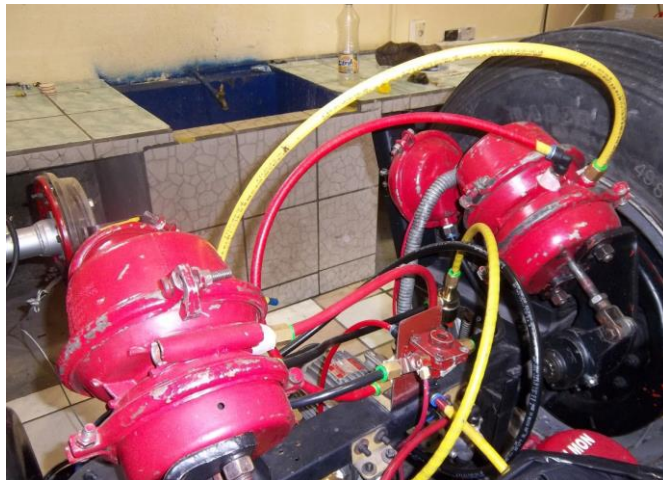
Figura 4.15: Cañerías de los frenos posteriores
