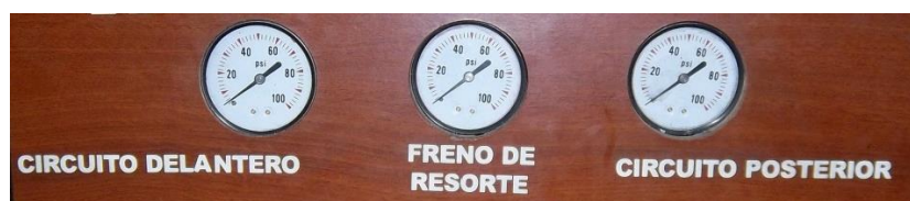
Figura 2.9: Medidor de presión
