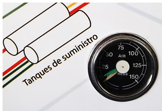
Figura 5.6: Manómetro del tanque
