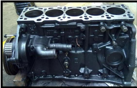
Figura1.1: Block del Motor.
