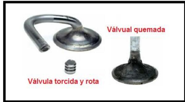
Figura 1.22: Válvulas Torcidas, Quemadas y Rotas.
