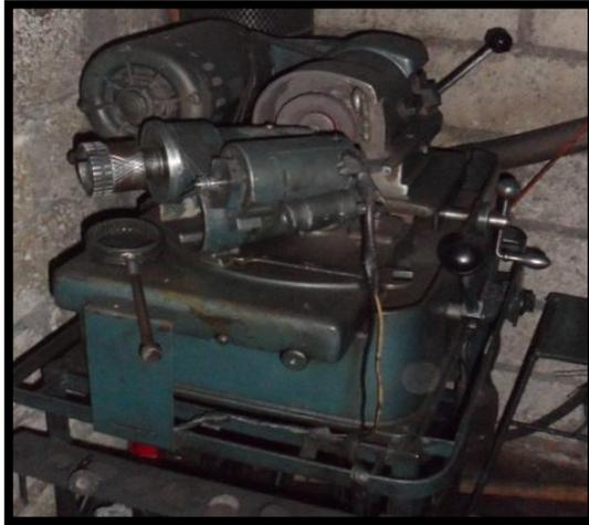
Figura 1.48: Rectificadora de Válvulas (RV-2).
