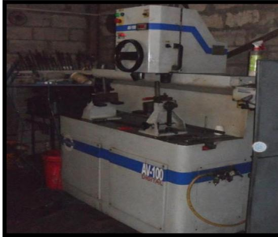
Figura 1.44: Rectificadora de Asientos de Culata (AV-100).
