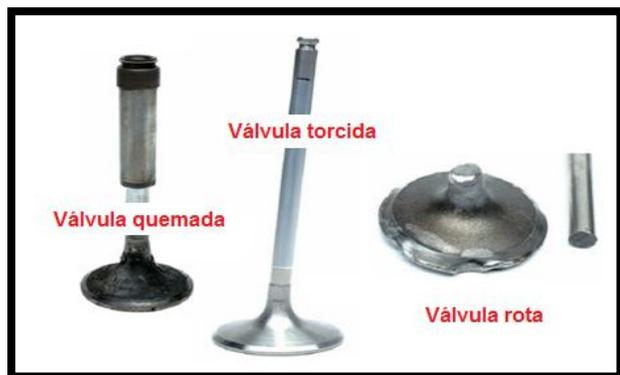
Figura 1.19: Válvulas Torcidas, Quemadas y Rotas.
