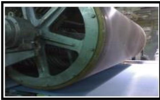
Figura 4.12: Enrollado de Papel en Bobinas.
