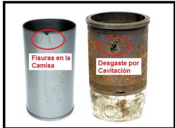
Figura1.8: Fisuras y Cavitación en las Camisas.
