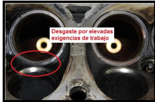
Figura 1.15: Desgaste por Picaduras.
