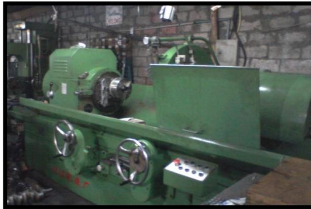
Figura 1.46: Rectificadora de Cigüeñales (RVC-1000M).
