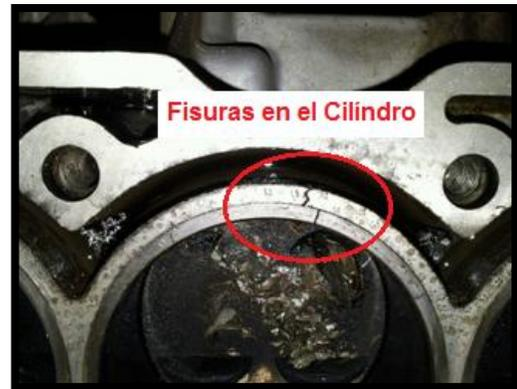
Figura 1.4: Fisuras en el Cilindro.
