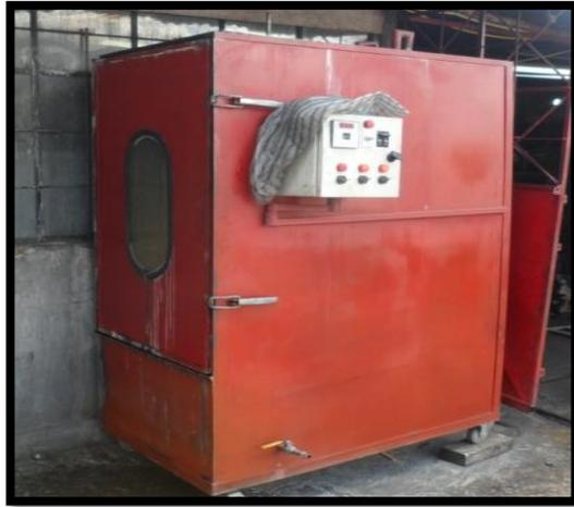
Figura 1.47: Lavadora de Piezas (Spray CV-200).
