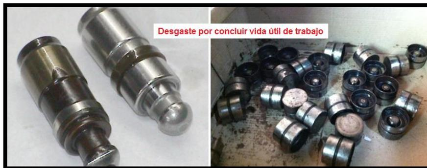
Figura 1.40: Daños y Desgastes en la Superficie del Taque.
