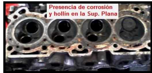
Figura 1.10: Desgaste por Corrosión.
