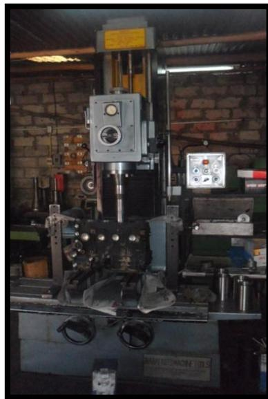
Figura 1.41: Rectificadoras de Cilindros (BVC-1600P).
