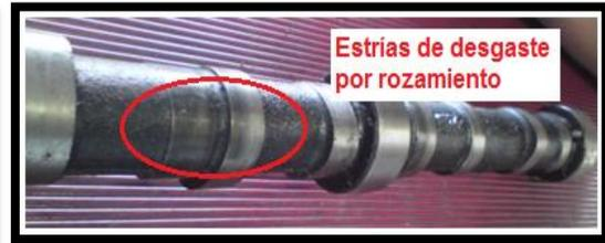
Figura 1.33: Estrías de Desgaste por Rozamiento.
