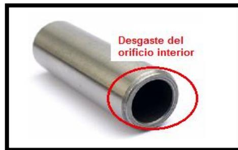
Figura1.12: Desgaste del Diámetro Interior.
