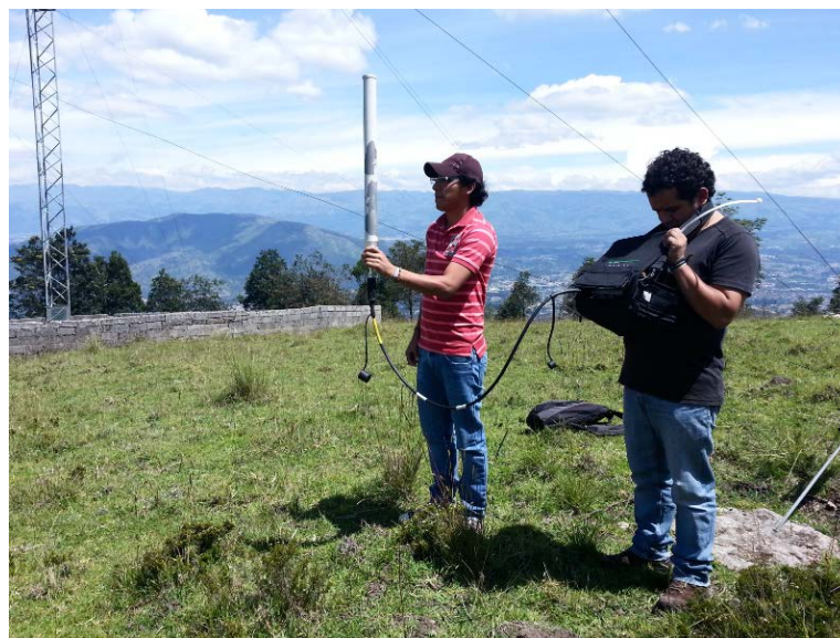
Figura. 2.31. Toma de lecturas en el rango de 5Ghz-6Ghz, antena vertical con dirección a la Espe
