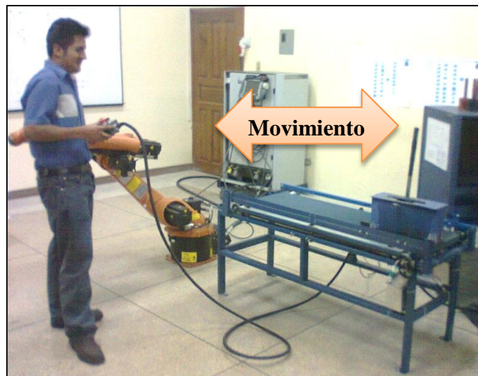
Fig. 6.43 Prueba de la banda transportadora con 10 kgf.
