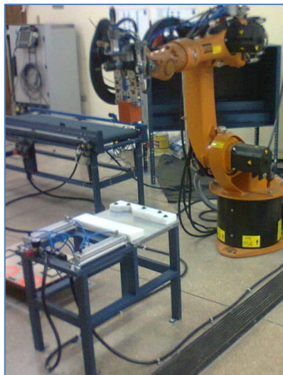
Fig. 6.3. Disposición de la estación de Procesamiento (Entenalla).
