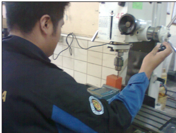
Fig. 6.55 Taladrado de cinco orificios con un taladro de banco
