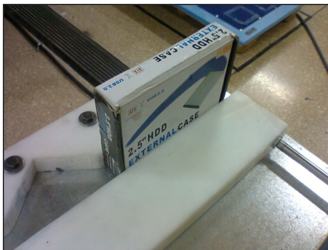
Fig. 6.49 Sujeción de una caja de cartón con la entenalla automatizada.
