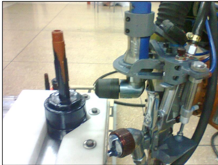
Fig. 6.46 Taladrado horizontal de una probeta sujeta por la entenalla automatizada.
