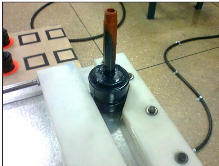
Fig. 6.45 Sujeción de objetos cilíndricos de la entenalla automatizada.
