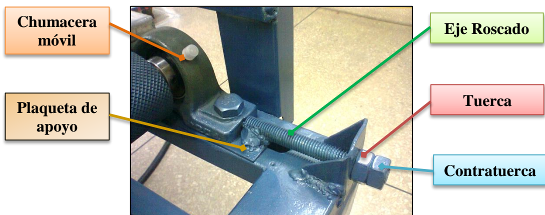
Fig. 3.38 Tensores de la banda transportadora
