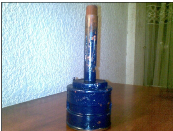
Fig. 6.51 Acabado de una probeta cilíndrica pintada a una presión de 0.5 bar.
