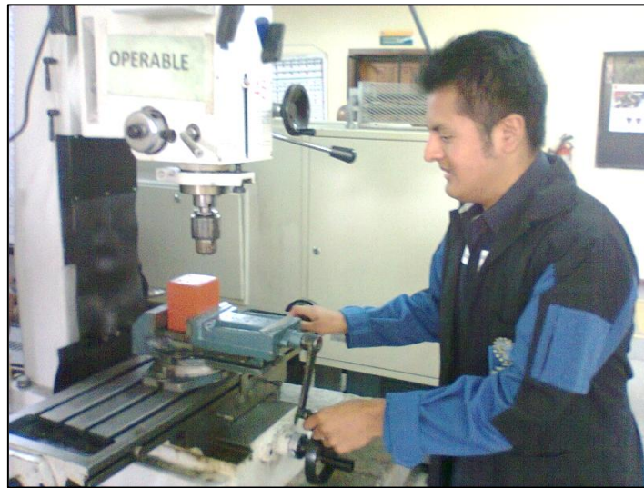
Fig. 6.54 Colocación de la probeta prismática en un taladro de banco
