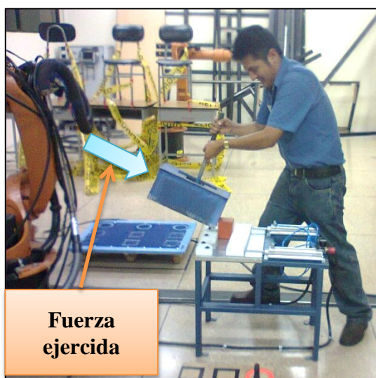
Fig. 6.48 Verificación práctica de la fuerza de sujeción de la entenalla automatizada.
