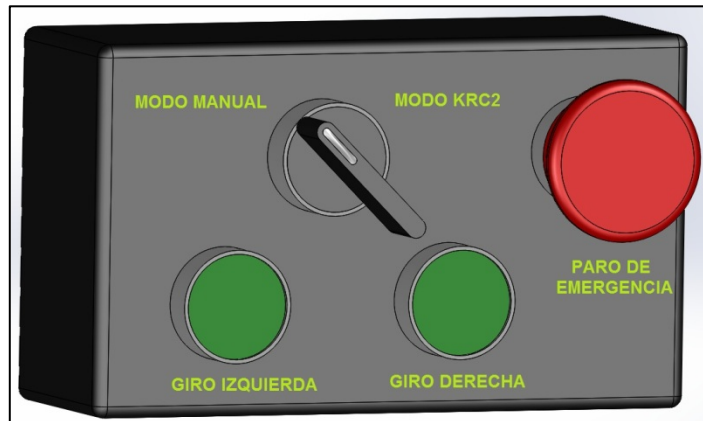
Fig. 3.57 Controlador propio banda transportadora
