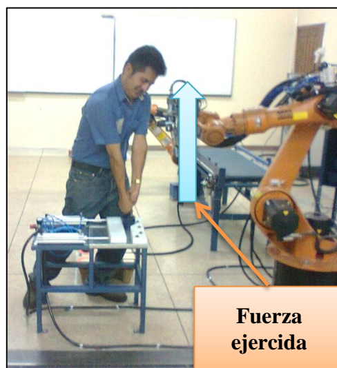
Fig. 6.47 Verificación práctica de la fuerza de sujeción de la entenalla automatizada.
