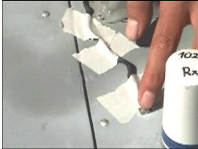
Figura 6.40. Montaje del acelerómetro
