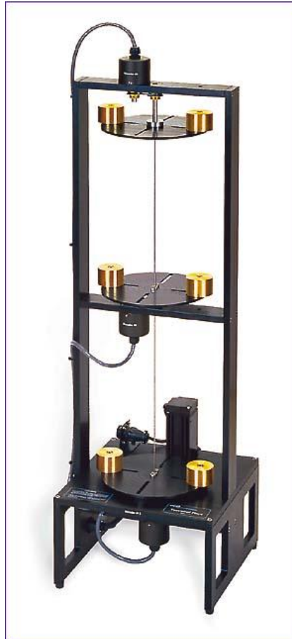
Figura 2.16. Dispositivo para medición de vibraciones Torsionales
