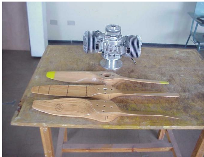
Figura 4.3. Motor MEGGITT WAE 342 y hélices
