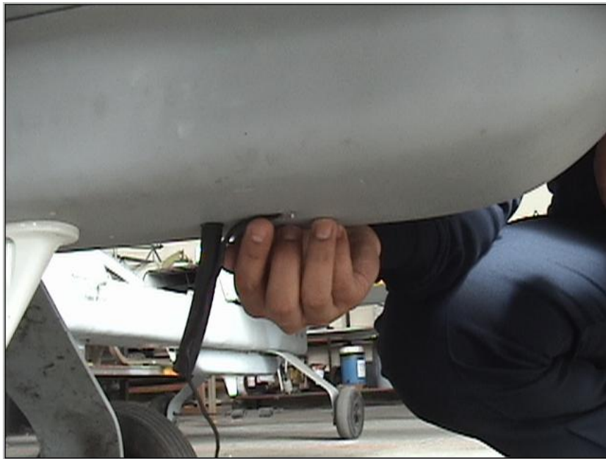
Figura 5.6. Colocación acelerómetro parte inferior del fuselaje
