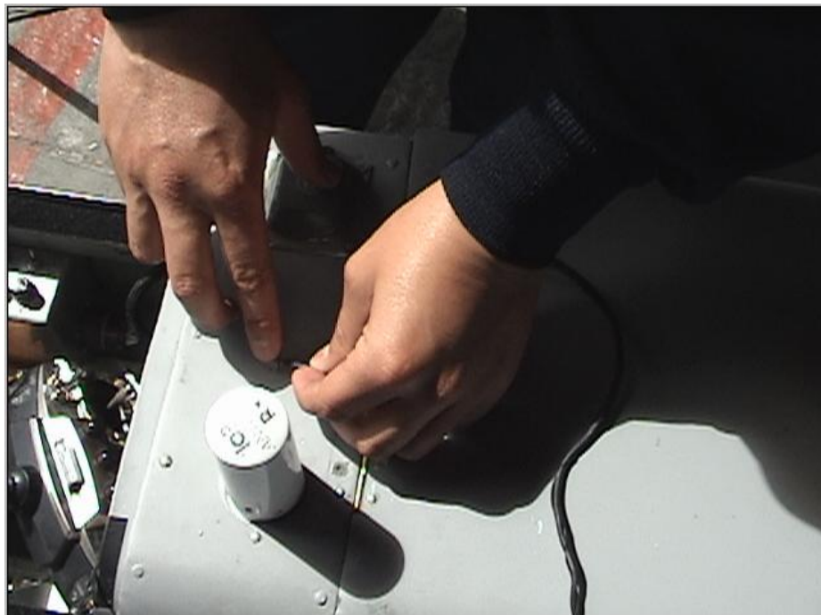
Figura 5.5. Colocación acelerómetro parte superior del fuselaje
