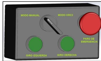
Fig. 11. Controlador propio banda transportadora
