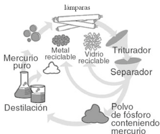
Figura. 2. 8. Proceso General de Reciclaje de Lámparas Fluorescentes
