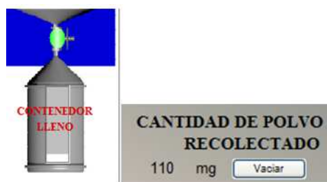
Figura. 5. 11. Alerta de Contenedor de Polvo Lleno
