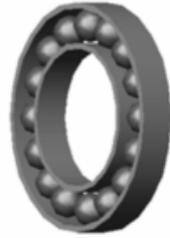
**Figura. 2.7. Cojinete de rodamiento**
