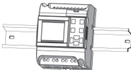
Figura. 6.17. Colocación del PLC en el riel del Panel de Control
