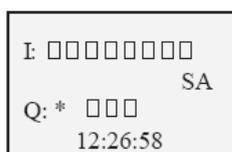
9. Presionar simultáneamente las teclas [OK] y [ESC] para acceder al PLC. El PLC cuenta con una clave de protección así que la siguiente pantalla aparecerá:
