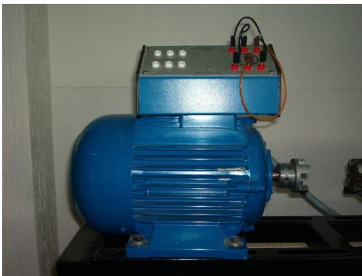
**Figura. 1.1. Motor de Jaula de ardilla utilizado en el proyecto**
