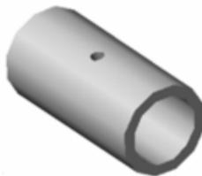
Figura. 2.6. Cojinete de deslizamiento
