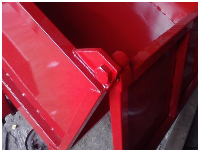
Figura 4.27. Acople de la puerta trasera
