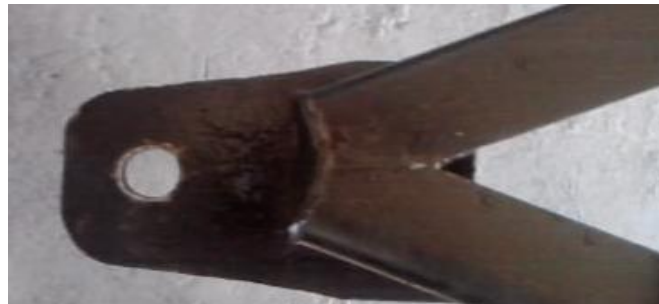
Figura 4.19. Lengua del remolque
