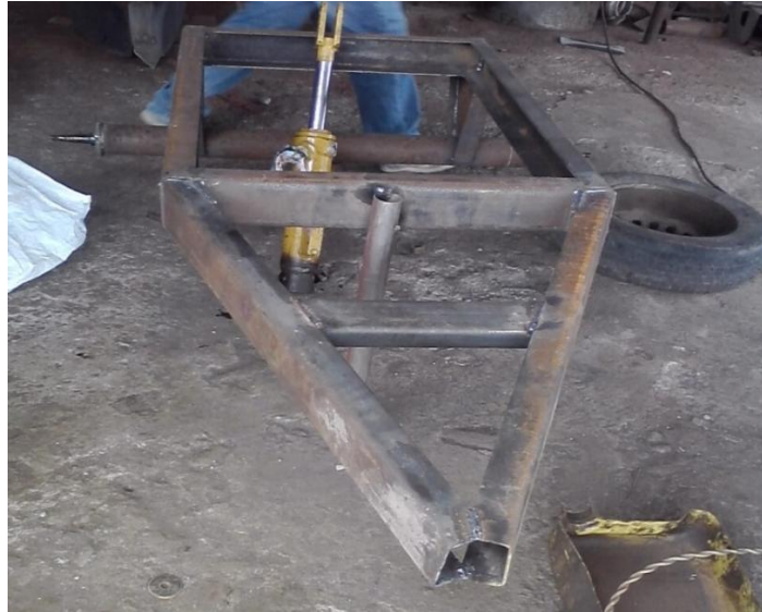
Figura 4.18. Tiro del remolque
