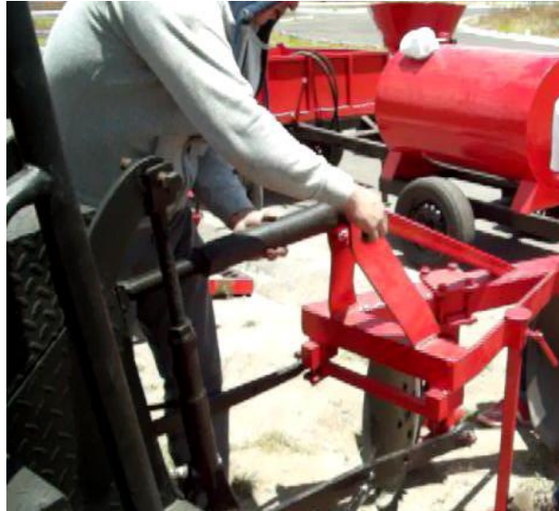
Figura 5.5. Enganche del tercer punto al arado
