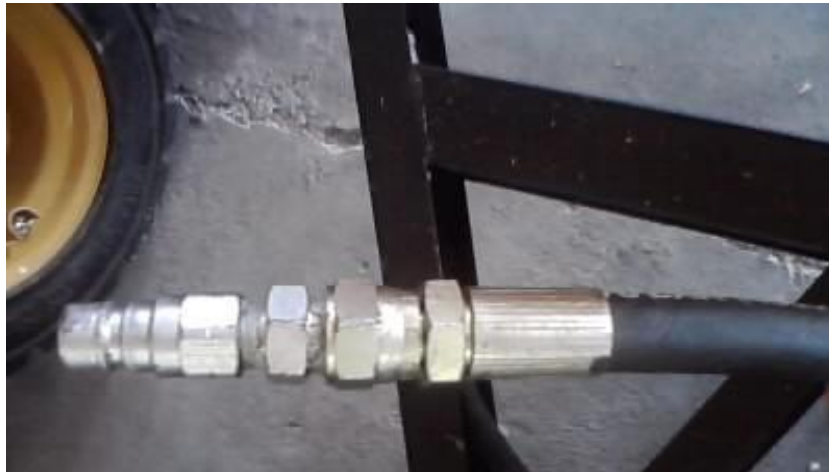
Figura 3.68. Conexión de acoples rápidos Fuente: Grupo de Investigación
