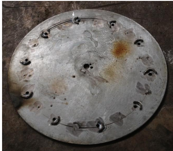
Figura 4.6. Construcción de la rueda guía
