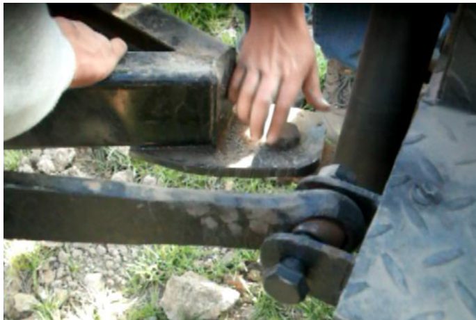
Figura 5.13. Pasador de la lengua del remolque
