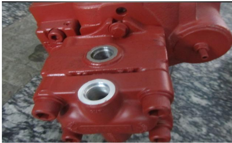
Figura 3.62. Bomba de engranajes NACHI
