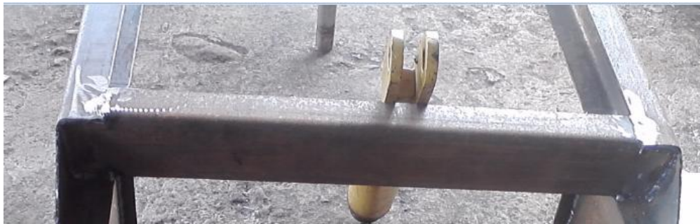
Figura 4.15. Junta a tope del perfil estructural U
