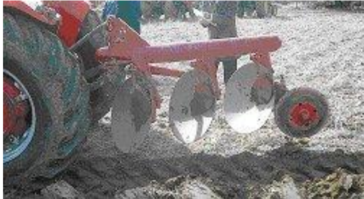
Figura 2.4. Arado de discos suspendidos
