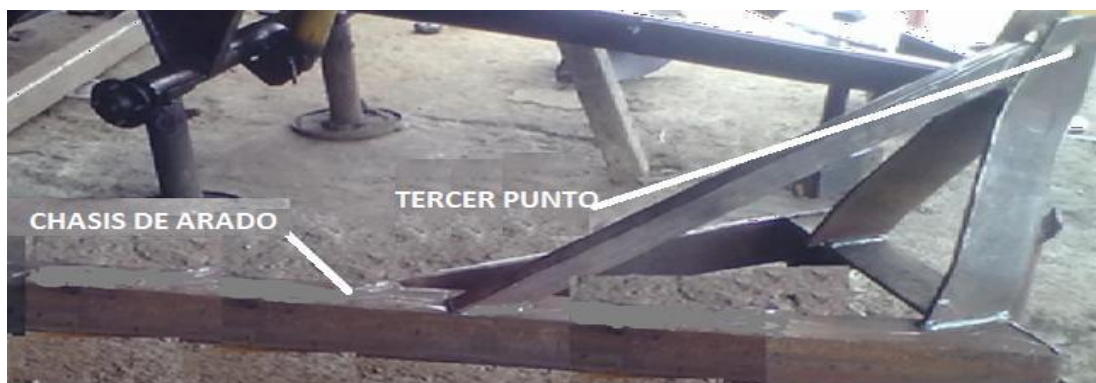
Figura 4.2. Construcción del chasis del arado
