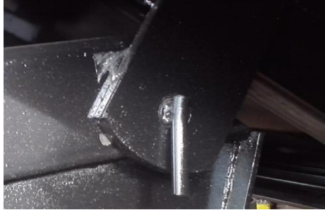
Figura 4.17. . Unión del chasis principal con el cajón
