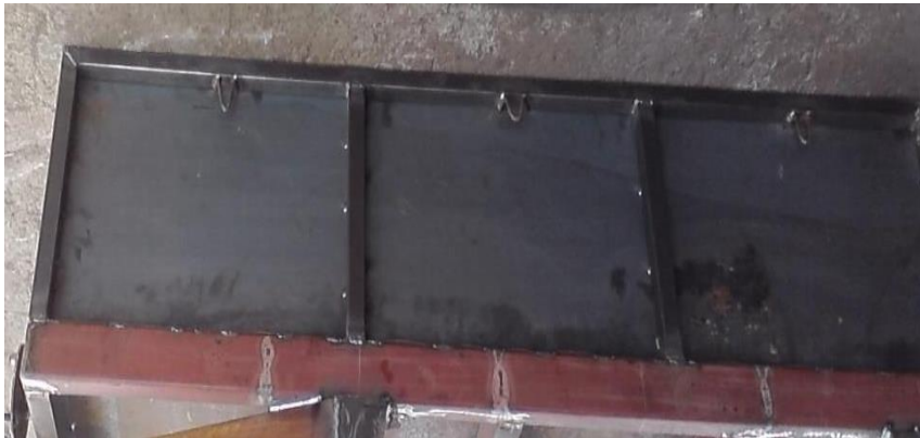
Figura 4.25. Estructura con tubo cuadrado y tol negro
