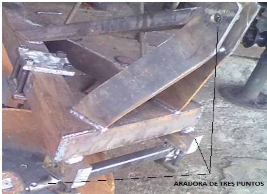
Figura 4.3. Aradora de tres puntos
