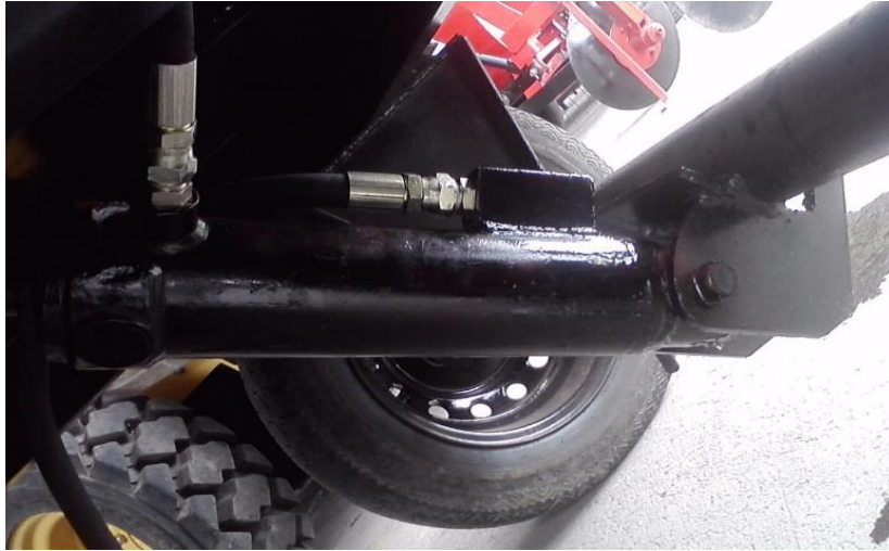
Figura 3.67. Conexión de las mangueras hidráulicas al cilindro Fuente: Grupo de Investigación
