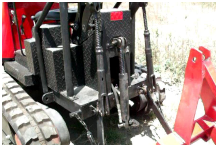
Figura 5.4. Posición del arado previo al enganche
