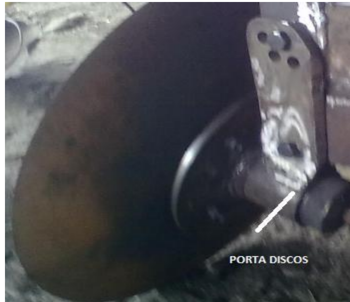
Figura 4.5. Construcción del porta discos del arado de discos
