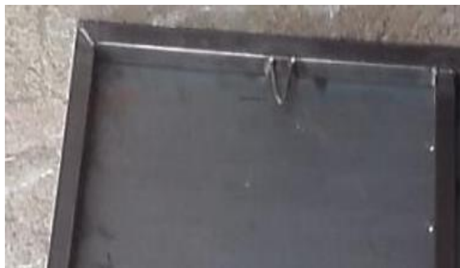
Figura 4.26. Junta a tope de los tubos cuadrados
