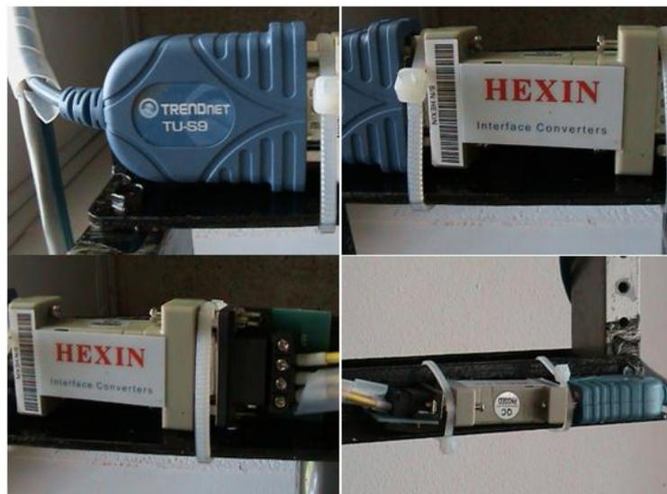
**Figura 4.45 Conexiones entre los Conversores RS485-RS232 y RS232-USB**
