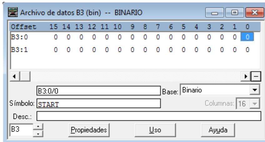
**Figura 4.2 Creación de Tag's en RSlogix 500**
