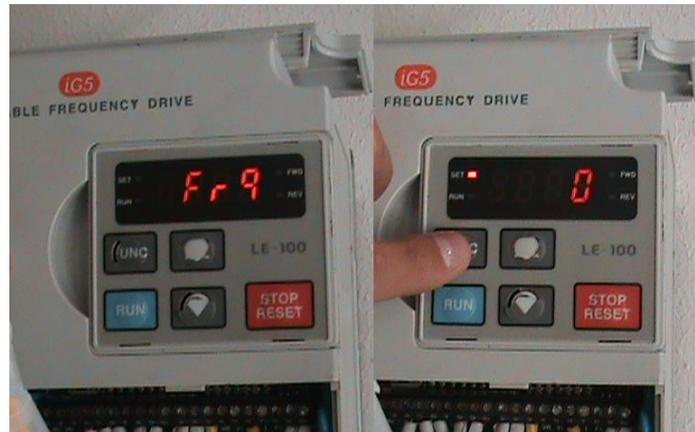
**Figura 4.9 Seteo del parámetro DRV-04 por Consola**
