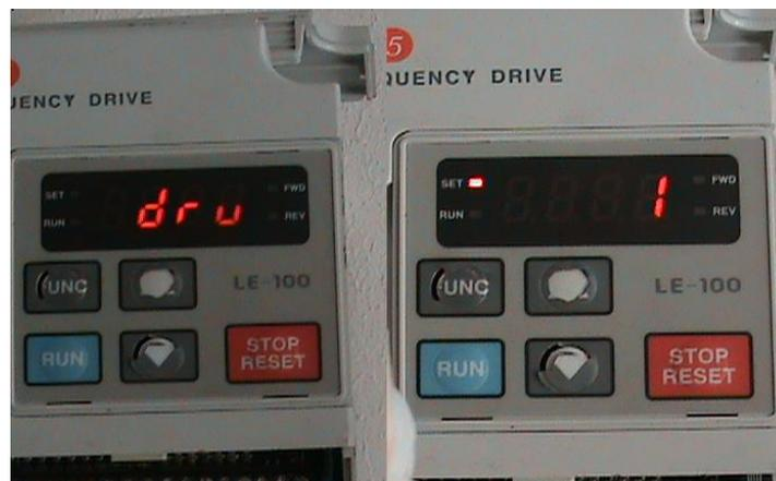
**Figura 4.8 Seteo del parámetro DRV-03 por Consola**
