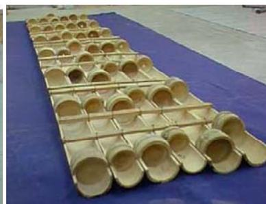
b.- Refuerzo de Bambú con caña completa a modo de conector
