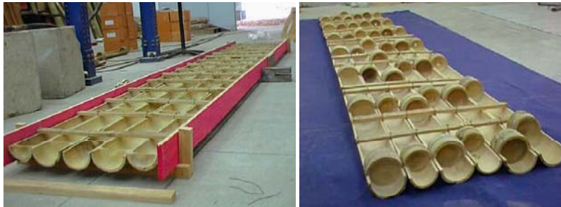
a.- Refuerzo de Bambú con media caña a modo de conector
