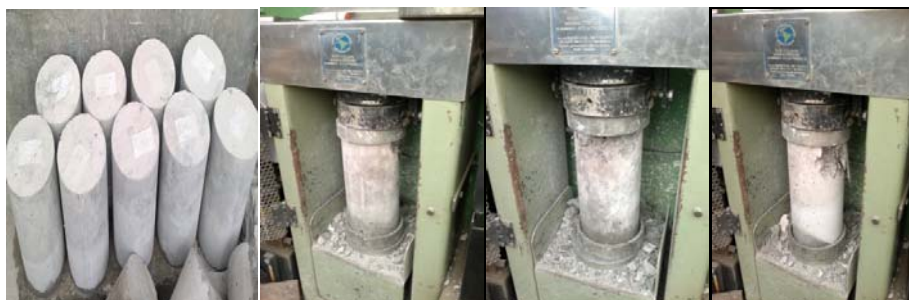
Figura 4.19: Cilindros Ensayados a Compresión (Laboratorio ASHOSUE CIA. LTDA.)
