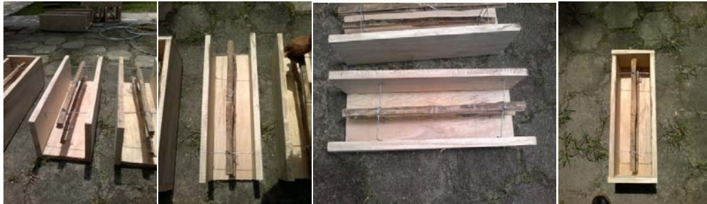
Figura 4.14: Molde de Madera bajo la Norma ASTM C78
