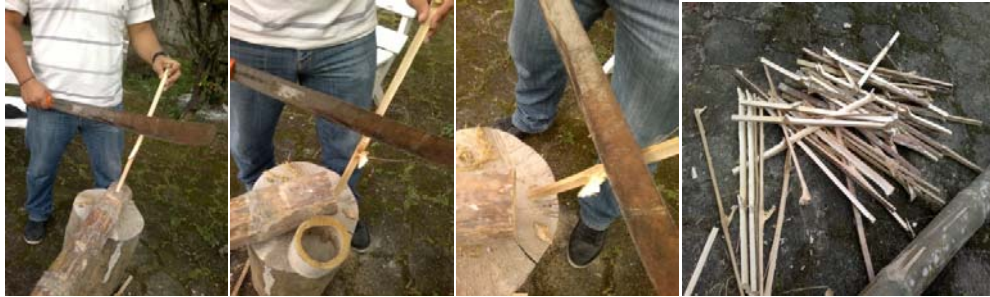
Figura 4.10: Limpieza de las Latillas de Caña Guadua
