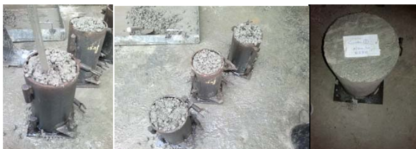
Figura 4.17: Cilindros Testigos para Medir la Resistencia del Hormigón a Compresión (Laboratorio ASHOSUE CIA. LTDA.)
