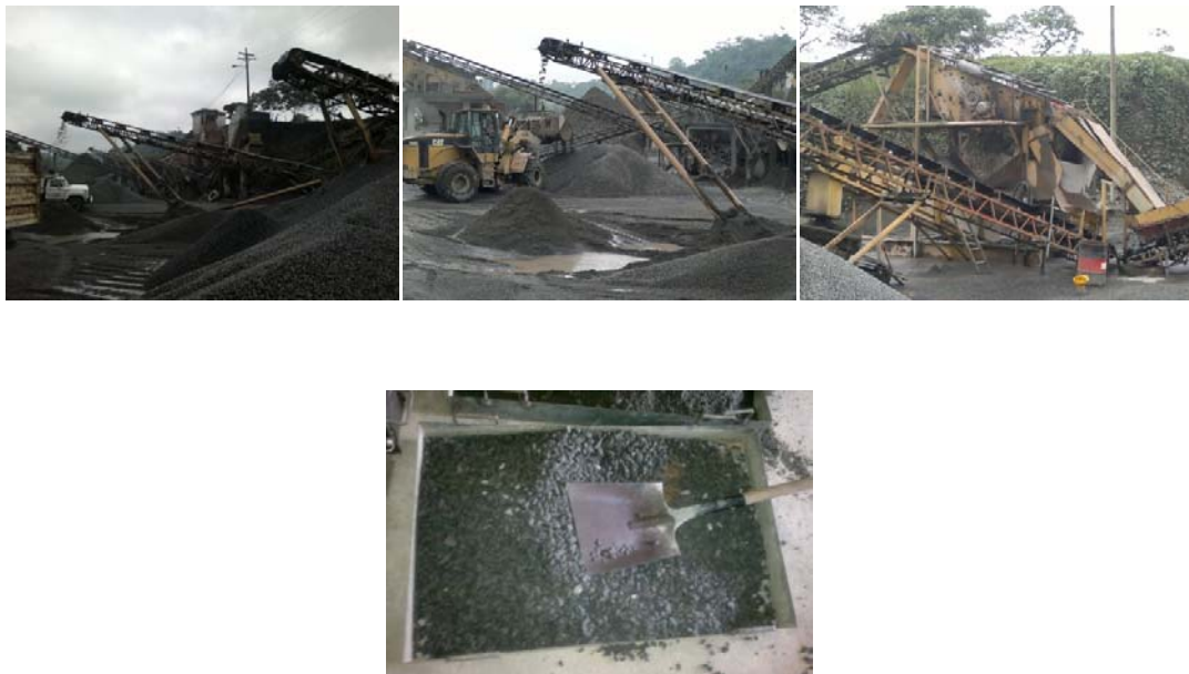
Figura 4.3: Obtención de la Muestra en Planta; Preparación de la muestra a Ensayar
