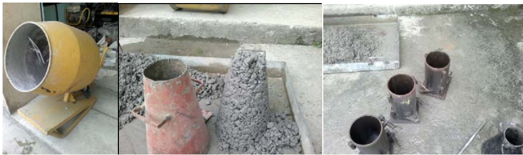
Figura 4.16: Preparación de la Mezcla y Especímenes de Prueba
