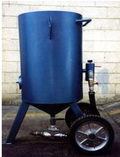
Fig. 2.17 Equipo de Sandblasting por Presión 11
