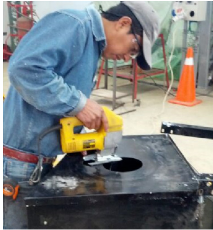
Fig. 5.2 Abertura de Paredes Laterales.
