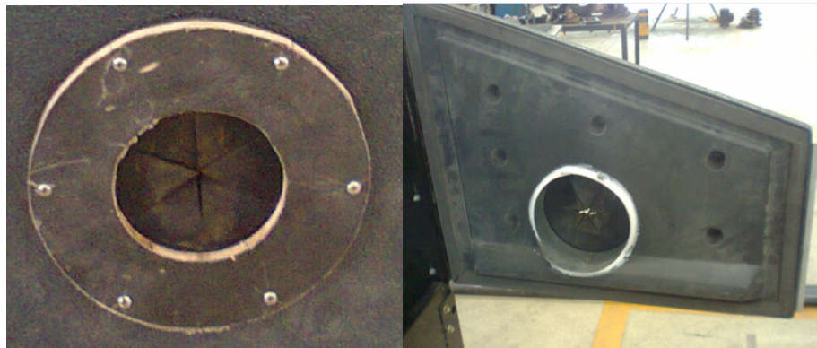
Fig. 5.3 Membranas de Paredes Laterales.
