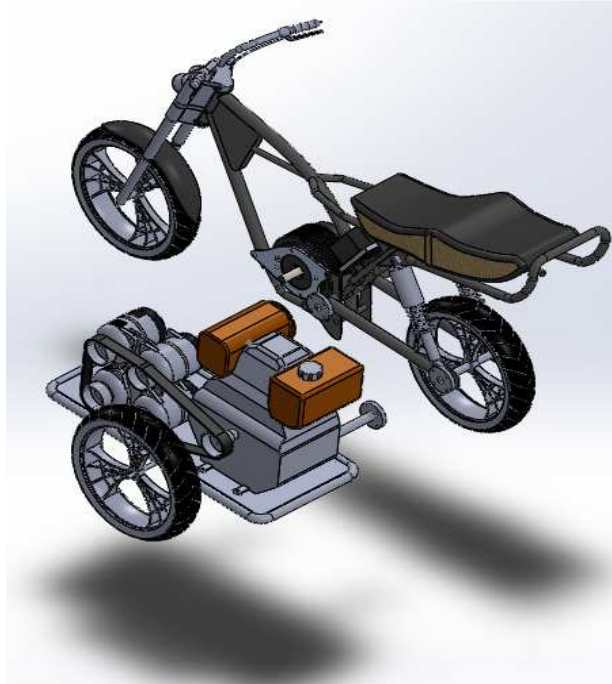
Figura 3.79. Motocicleta con bridas de conexión.
