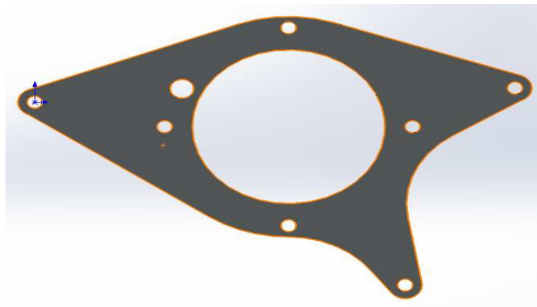
Figura 3.21. Diseño geométrico de placa soporte del motor - SolidWorks
