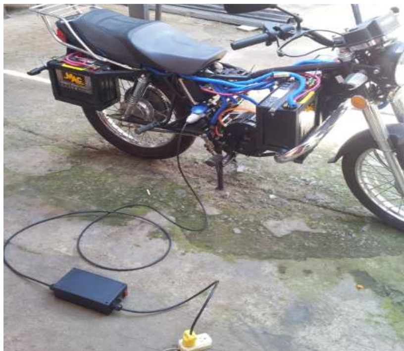
Figura 4.31. Cargador 48 voltios 3 amperios - funcionamiento
