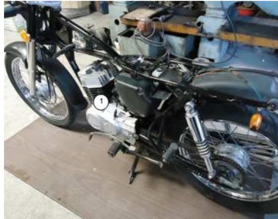
Figura 4.4. Motocicleta Suzuki Ax100 desmontado las cubiertas laterales.
