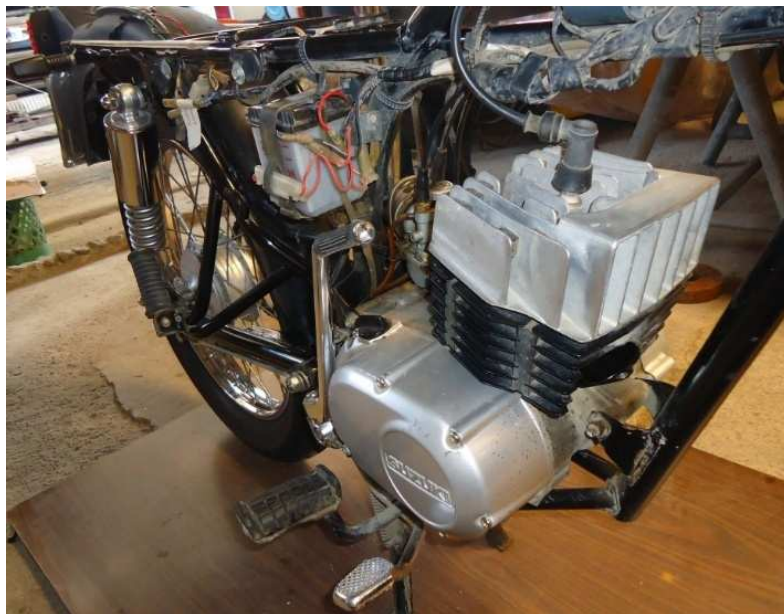
Figura 4.6. Motocicleta Suzuki Ax100 desmontado el sistema de escape.
