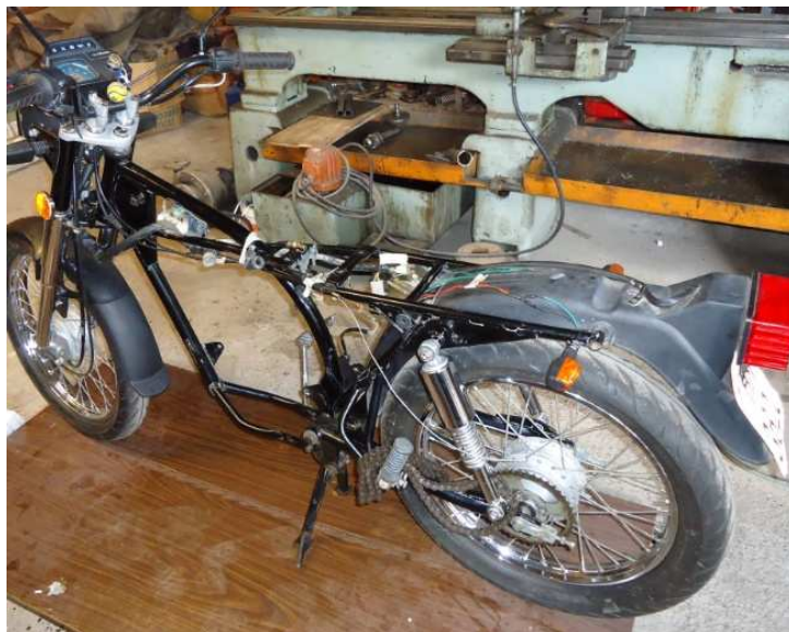
Figura 4.10. Motocicleta Suzuki Ax100 desmontado el motor.
