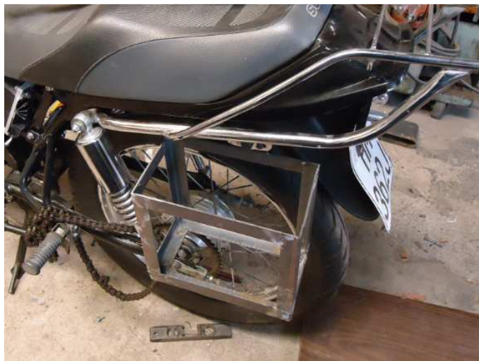
Figura 4.19. Ubicación y comprobación del soporte de baterías posterior.
