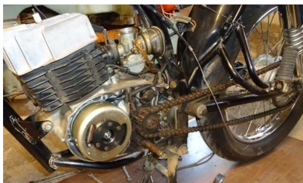
Figura 3.44. Relación de transmisión con motor a Gasolina i=3 .
