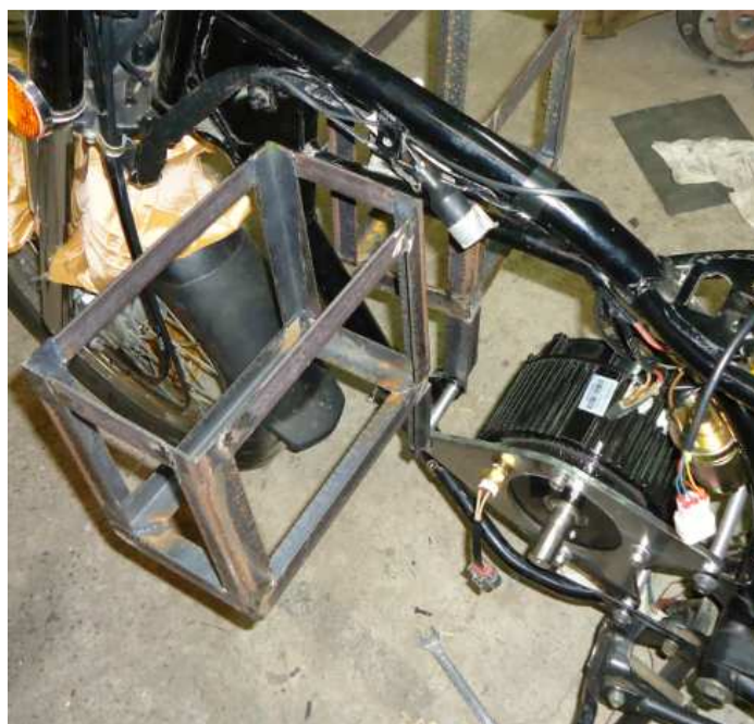
Figura 4.20. Ubicación y comprobación de soporte de baterías delantero
