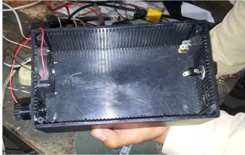
Figura 4.29. Caja del cargador de baterías
