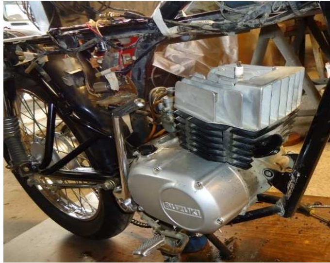
Figura 4.9. Motocicleta Suzuki Ax100 desmontado cables de aceleración y ahogador.
