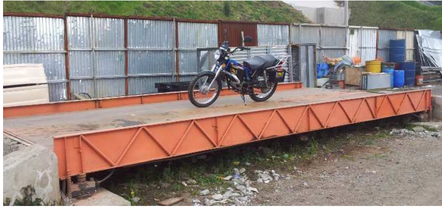
Figura 3.4. Motocicleta en Balanza digital – peso seco 130kg
