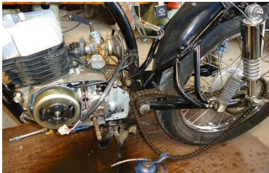
Figura 4.8. Motocicleta Suzuki Ax100 desmontado la cadena de transmisión.
