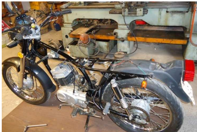
Figura 4.5. Motocicleta Suzuki Ax100 desmontado depurador y depósito de aceite 2T.
