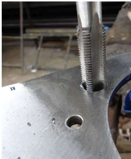
Figura 4.14. Rectificado de placa soporte del motor y machuelado M16
