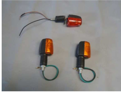
Figura 3.63. Cambio de luces direccionales a 12v
