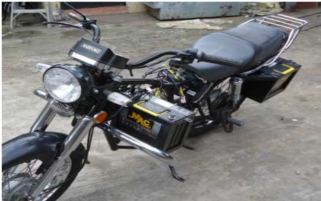
Figura 4.21. Comprobación de la ubicación de baterías.
