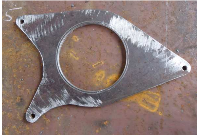
Figura 4.13. Perforación de esquinas placa del motor – soportes en el chasis.
