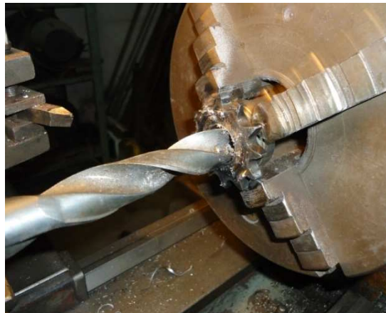
Figura 4.26. Maquinado de catalina conductora a diámetro del eje del motor.
