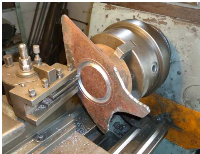
Figura 4.12. Torneado de placa – Soporte del motor.
