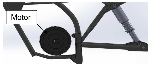
Figura 3.13. Diámetro máximo posible para instalación de motor.
