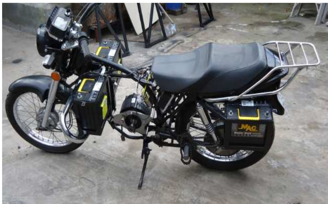
Figura 4.22. Comprobación de la ubicación de baterías.
