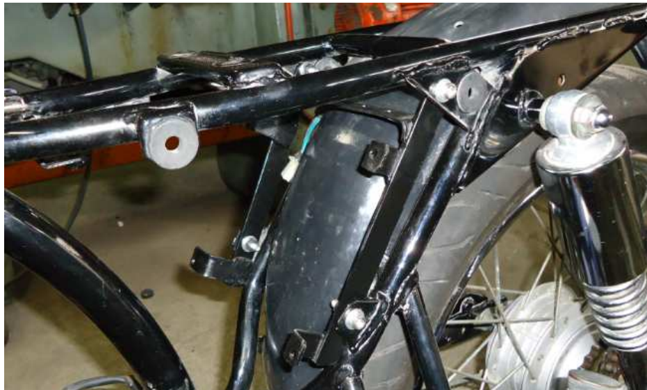
Figura 4.24. Ubicación del controlador en el chasis de la motocicleta.
