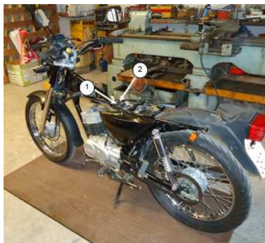
Figura 4.3. Motocicleta Suzuki Ax100 desmontado el Tanque de combustible
