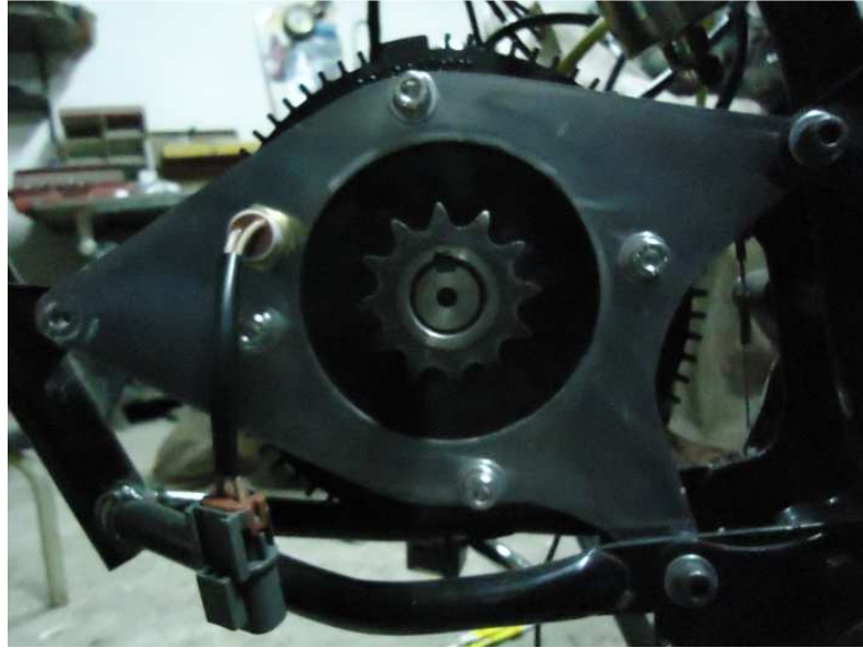
Figura 4.27. Comprobación de maquinado de la catalina conductora La catalina conductora (Figura 4.26) tiene una chaveta de 5mm (Figura 4.27).
