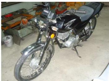
El motor a gasolina de 2 tiempos cuenta con una potencia de 10 hp y un torque máximo de 0.99 kg-m, que es suficiente para mover la
