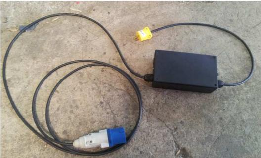
Para cargar las baterías se necesita un cargador de 48 voltios y de 3 a 5,5 amperios, debido a que se realiza una carga lenta para obtener el 100% de la capacidad de las baterías además aplicando una carga lenta se alarga la vida útil.
