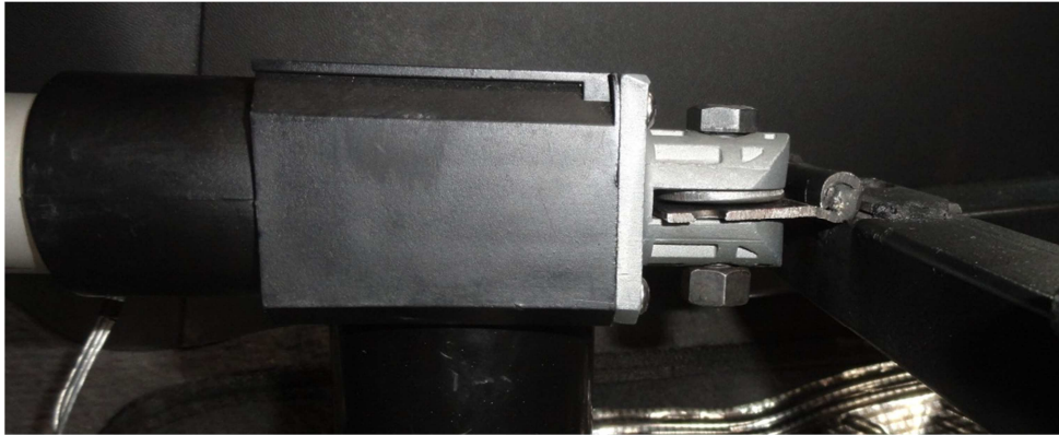
Figura 5. 3 Unión de estructura metálica con actuadores lineales
