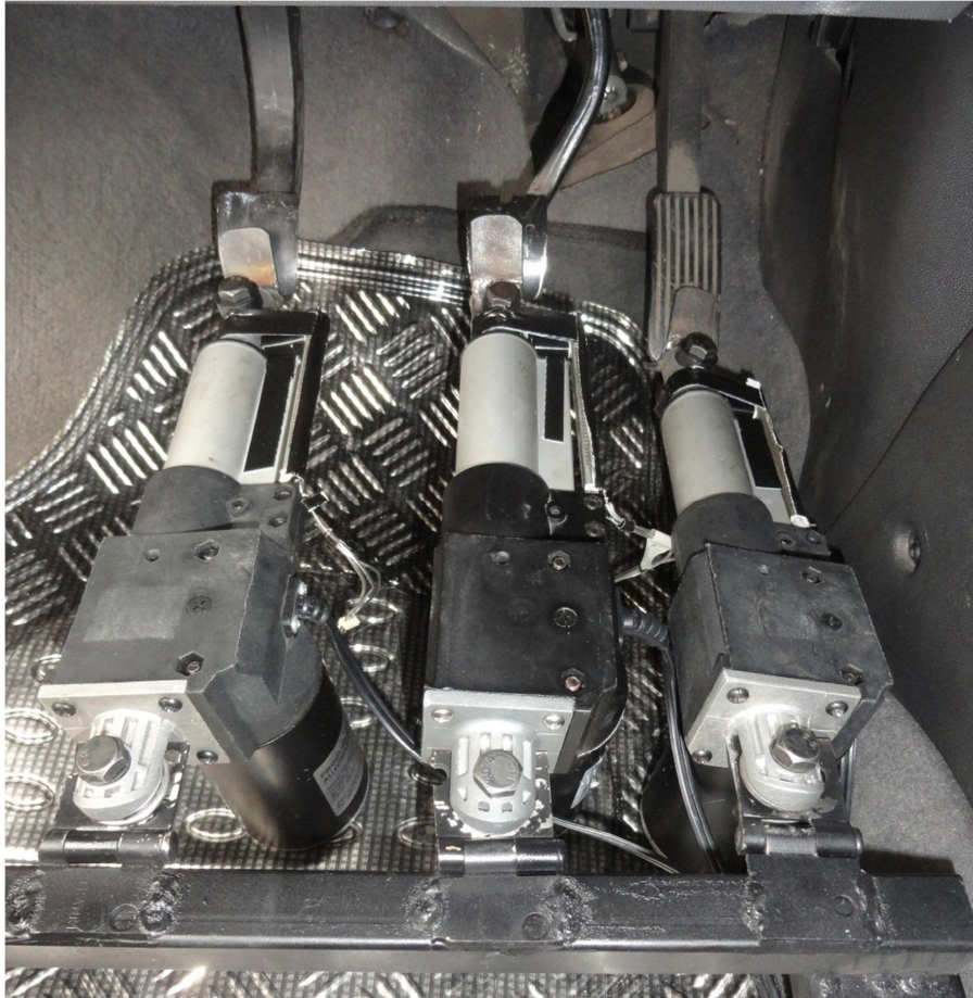
Figura 5. 2 Estructura metálica soporte para los actuadores
