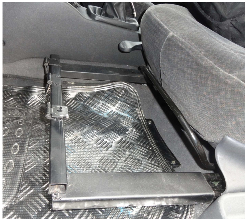
Figura 5. 1 Estructura montada sobre los rieles del asiento del conductor
