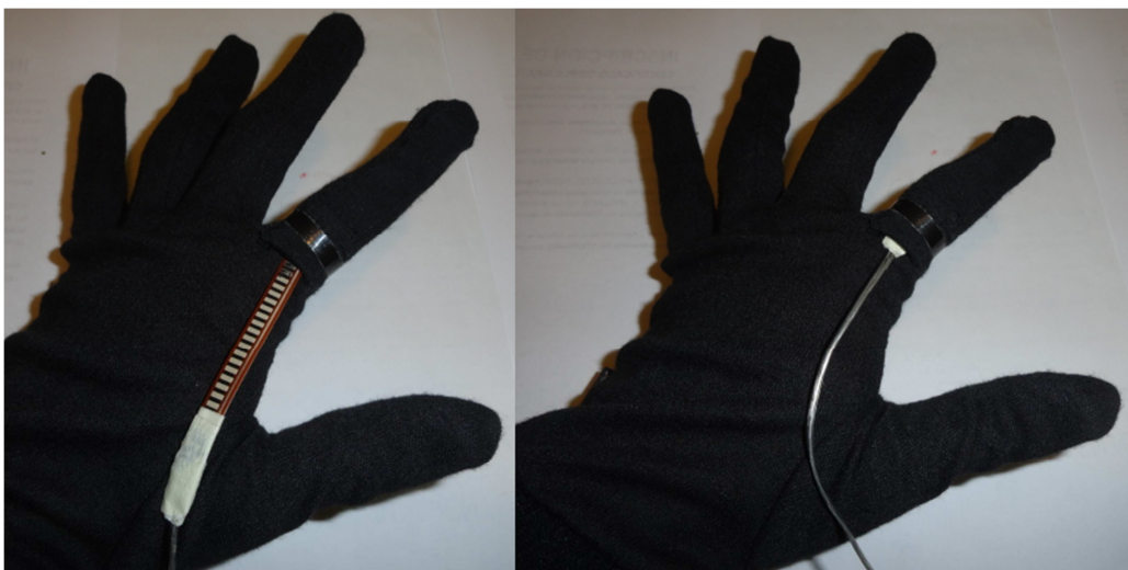
Figura 5. 7 Galga del freno en dedo índice de guante izquierdo
