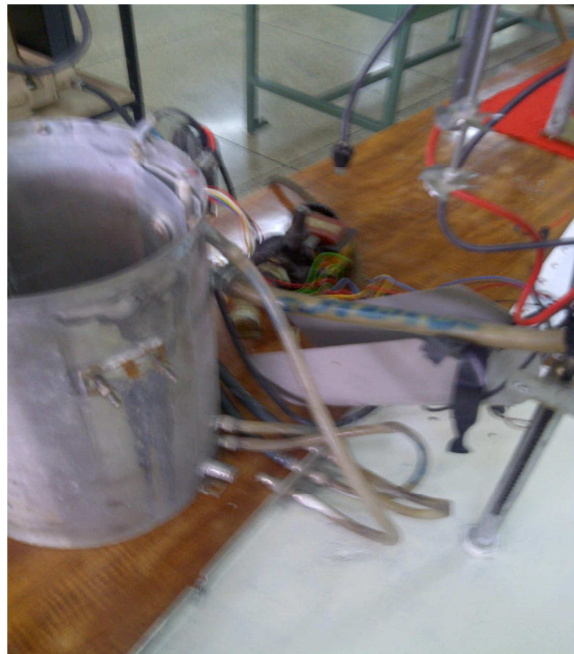
Figura 3.19 Verificación del mal estado de las mangueras por donde circula el agua de la bomba adiabática
