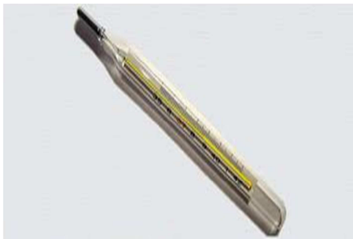
Figura 2. 1 Termómetro de mercurio
