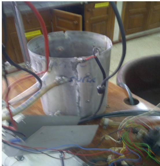
Figura 3.17 Mantenimiento del tambor de la Bomba Adiabática.
