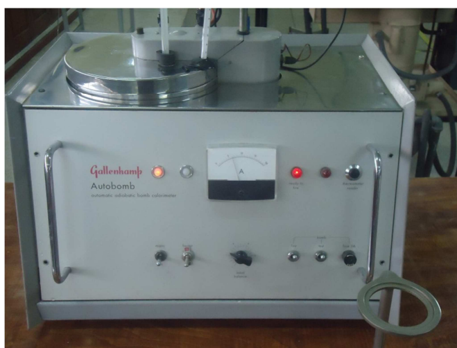
Figura 3.25 Funcionamiento de la Bomba Adiabática, lo cual no mostró ninguna deficiencia.
