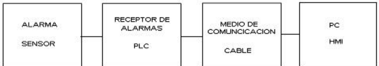
Figura 5.3: Diagrama de Bloques de la simulación
