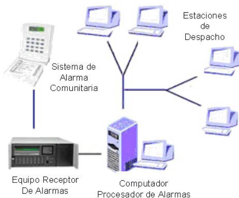
Figura 1.9: Esquema del sistema de alarmas comunitarias
