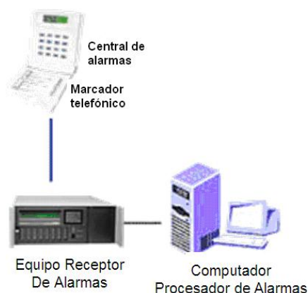
Figura 3.17: Sistema de monitoreo cableado
