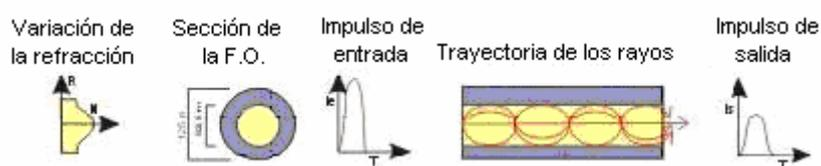
**Figura 1.27. Fibra multimodo de índice gradiente gradual**
