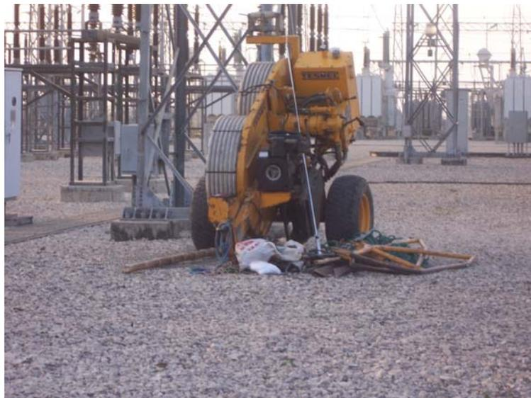
**Figura 2.20. Equipo de frenado donde se para la instalación del cable**
