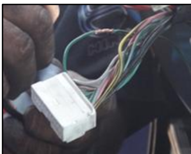
Figura 9. Conexión del cable de freno motor
