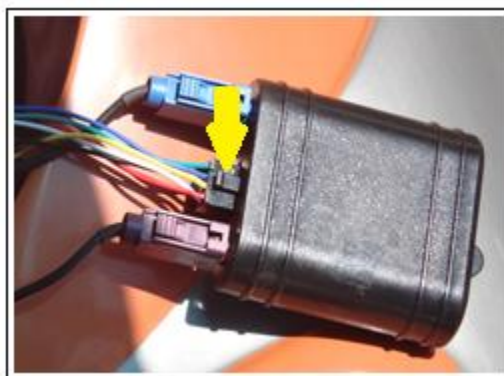
Figura 3.14 Conexión del arnés CBL048 con el AVL
