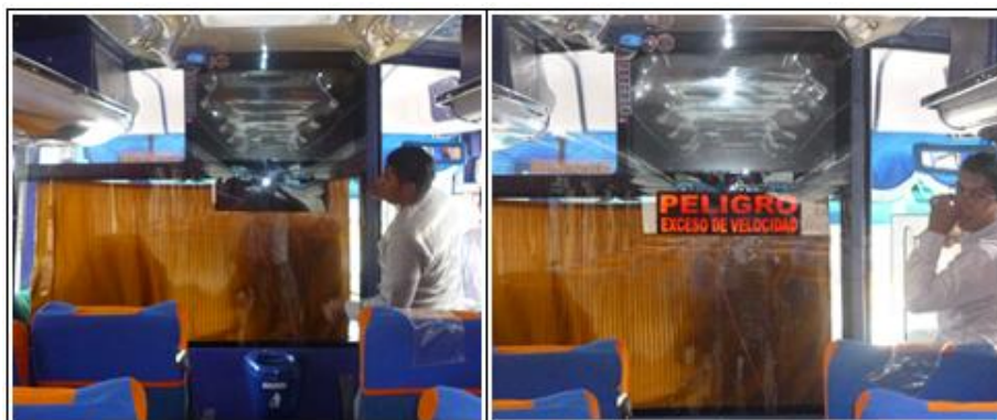
Figura 3.33 Localización del indicador de peligro
