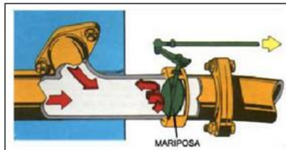
Figura 1.36 Freno motor con aleta de cierre en el tubo de escape
