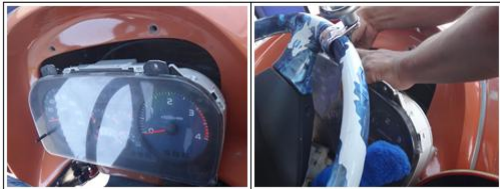
Figura 3.15 Desmontaje del panel de instrumentos
