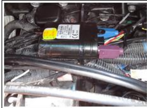
Figura 3.16 Ubicación del AVL-TT7850 en el autobús
