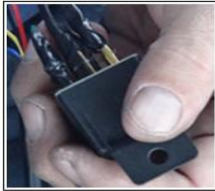
Figura 3.8 Relé de 24V que habilitara el encendido del autobús
