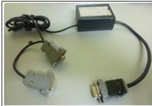
Figura 2.12 Interfaz de comunicación RS-232
