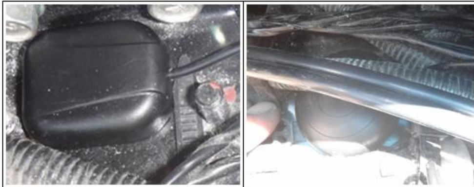
Figura 3.13 Ubicación de antenas GPS y GPRS en el autobús
