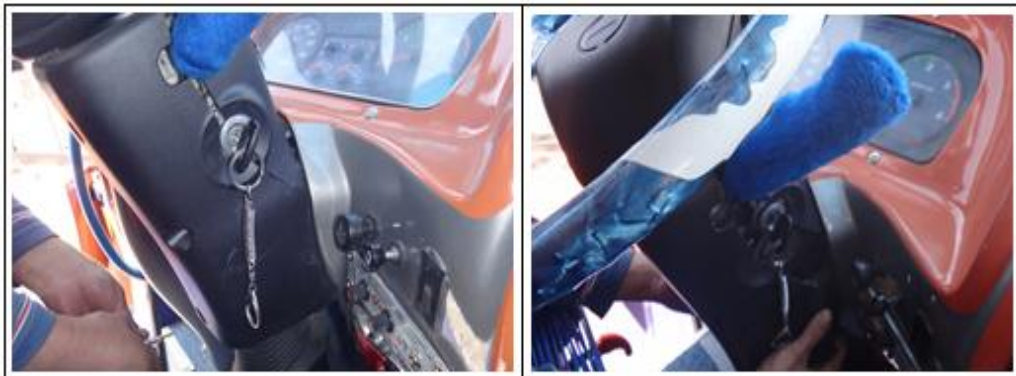
Figura 3.3 Desmontaje del protector de la columna de dirección
