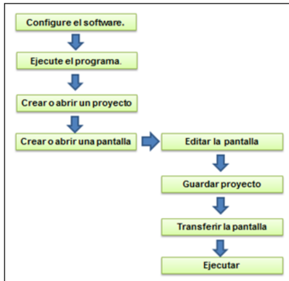
Figura 2.20 Estructura de programación de pantalla
