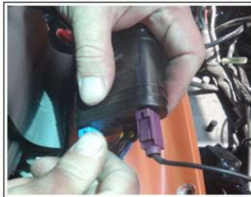
Figura 3.12 Conexión de antenas GPS y GPRS
