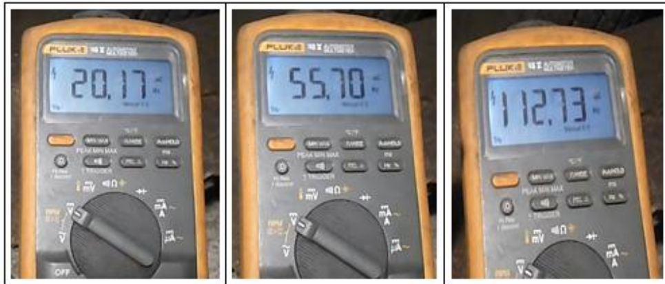
Figura 3.25 Medición de frecuencia a distintas velocidades
