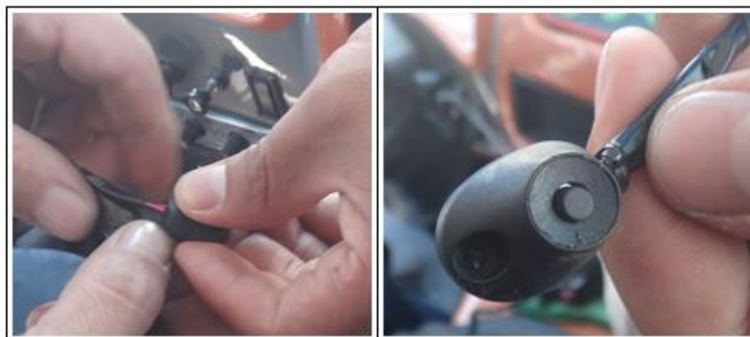
Figura 3.11 Conexión del botón de pánico
