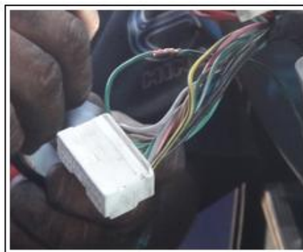
Figura 3.27 Conexión del cable de activación del freno motor
