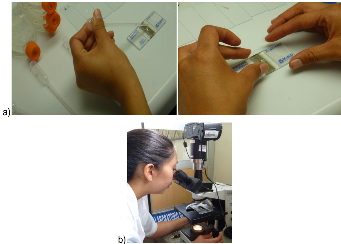
Figura 3.12: Recuento celular. a) Toma de muestra y cámara de Neubauer, b) Visualización en el microscopio.
