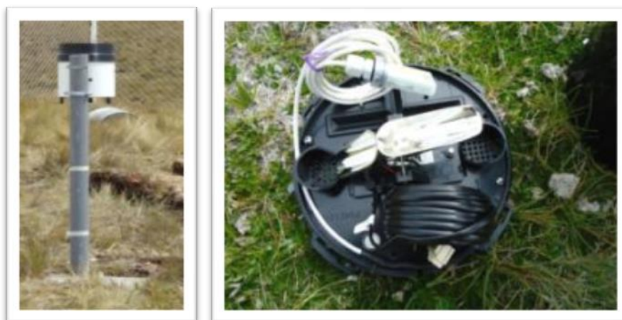
Figura 15. Pluviografos tipo balancín
