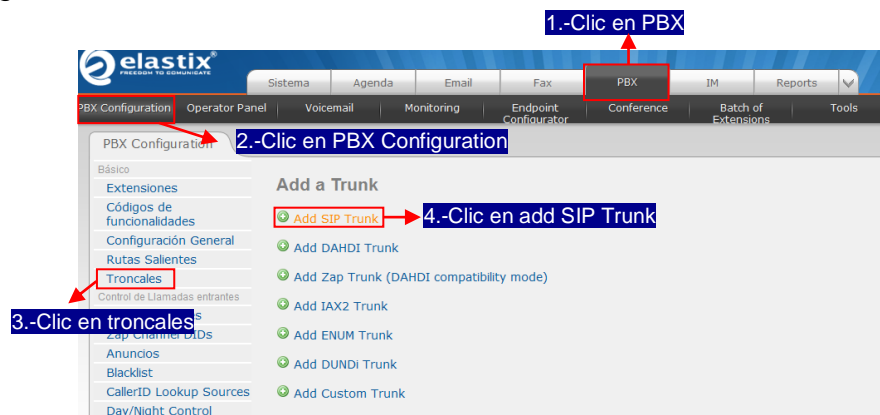
Figura 3. 120. Pasos para la creación de una troncal SIP
