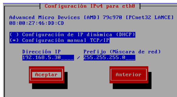
Figura A1.8. Configuración de red IPv4.
