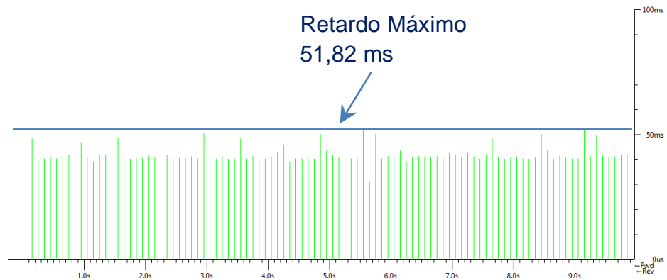
Figura 4. 34. Retardo máximo en una llamada IPv6 inalámbrico
