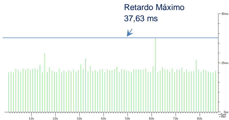
Figura 4. 48. Retardo máximo en una llamada IPv6-IPv4
