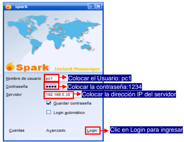
Figura 4. 62. Configuración de Spark
