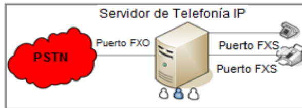
Figura 2. 3. Conexión a puertos FXS/FXO
