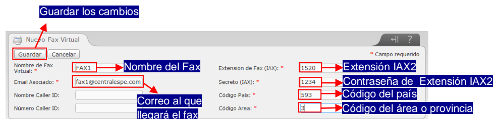
Figura 3. 106. Configuración del fax virtual
