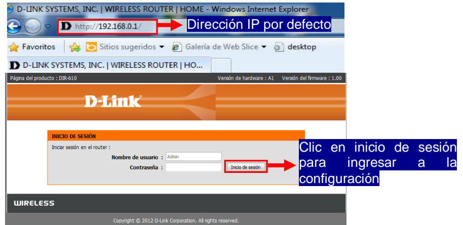
Figura 3. 9. Ingreso al router para su configuración
