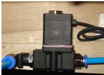
Figura 9. Válvula solenoide 12[V]
