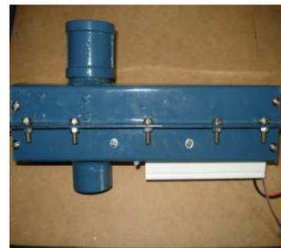
Figura 7. Compuerta dosificadora Prototipo
