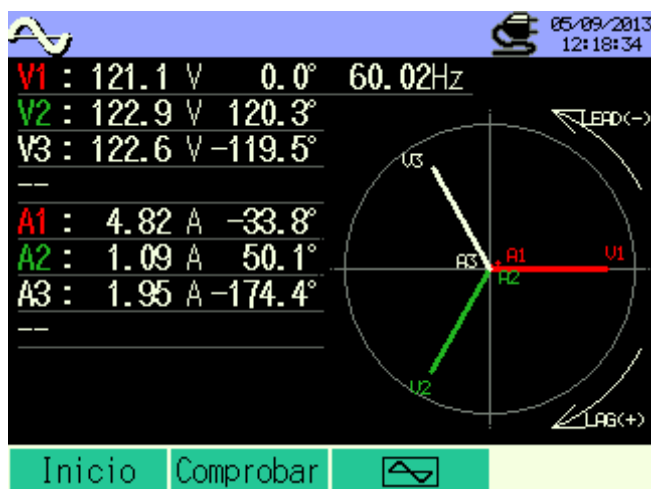
Figura 4. 17: Voltajes y corrientes en analizador de red portátil
