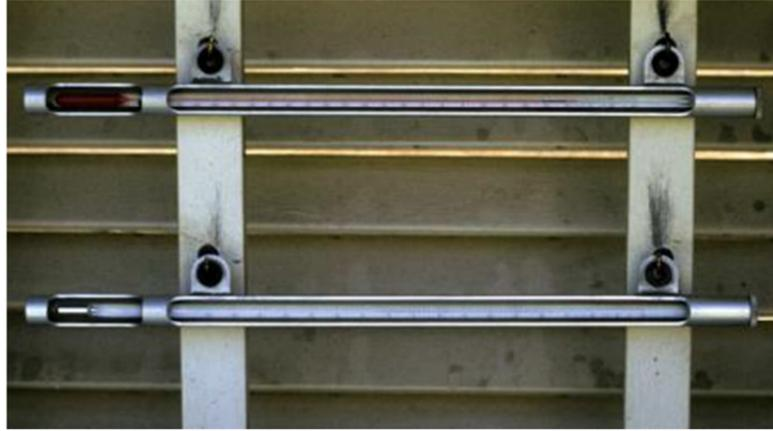
**Figura 5.** Termómetro de mínima, alcohol (arriba), termómetro de máxima, mercurio (abajo)
