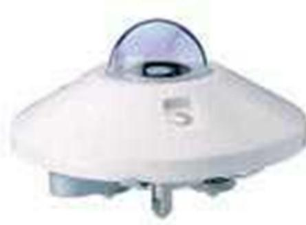
**Figura 12.** Solarímetro
