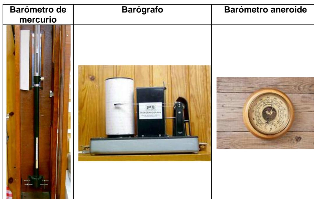
**Figura 14.** Tipos de medidores de presión
