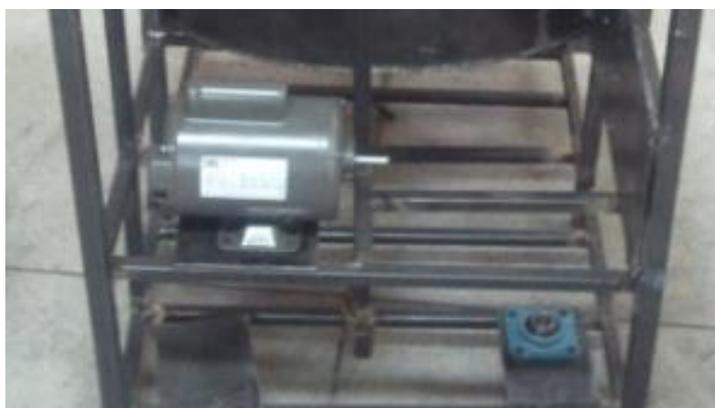
Fig 2. 18 Posicionamiento de la caja reductora y motor de 1 Hp en maquina tipo
