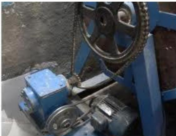
Fig 2. 17 Sistema de reducción caja reductora y polea
