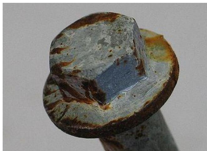
Fig 2. 13 Corrosión en acero A36
