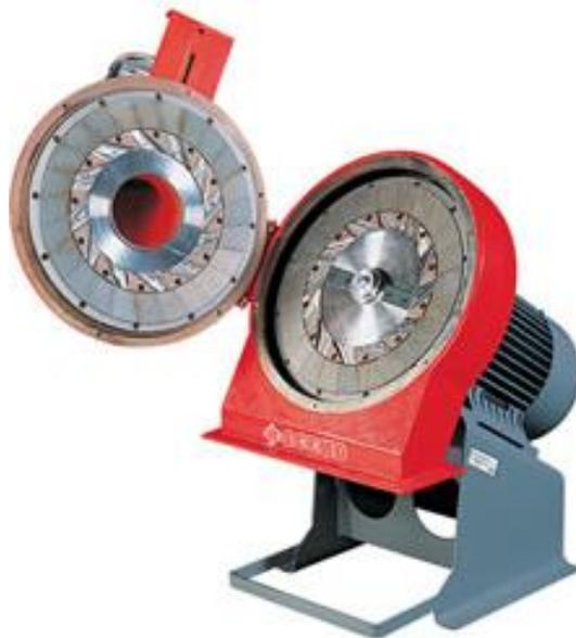
Fig 2. 3 Sistema de molino tipo disco
