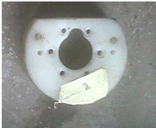
Figura 4.18 Acople del motor fabricado en duralon.
