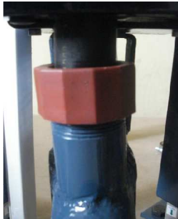
Figura 4.28 Unión de la salida del molino a la entrada del sistema de transporte.
