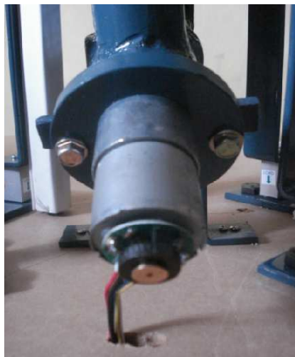
Figura 4.24 Motor DC acoplado al tornillo sin fin.
