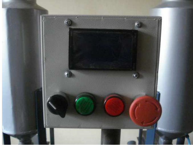
Figura 4.30 Panel indicador con pantalla GLCD y botones para el encendido principal del sistema.
