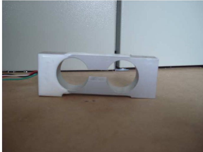
Figura 3.7 Celda de carga con capacidad para 10 kg.
