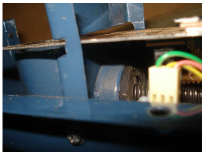
Figura 4.17 División intermedia col el alojamiento del rodamiento soldado.
