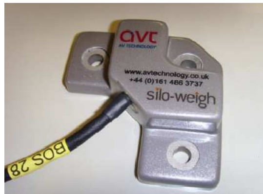
Figura 2.7 Sensor de deformación de tres agujeros de AV Technology
