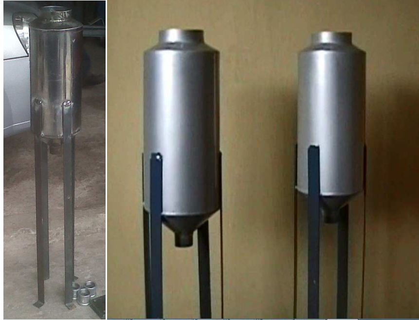
Figura 4.10 Silos de acero inoxidable acoplado a los soportes por medio de soldadura.
