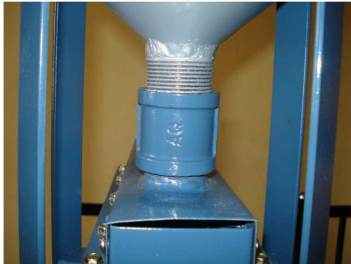
Figura 4.27 Unión del silo con la compuerta.
