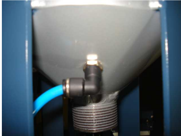
Figura 4.11 Implementación del fluidificador en la pared de la tolva.
