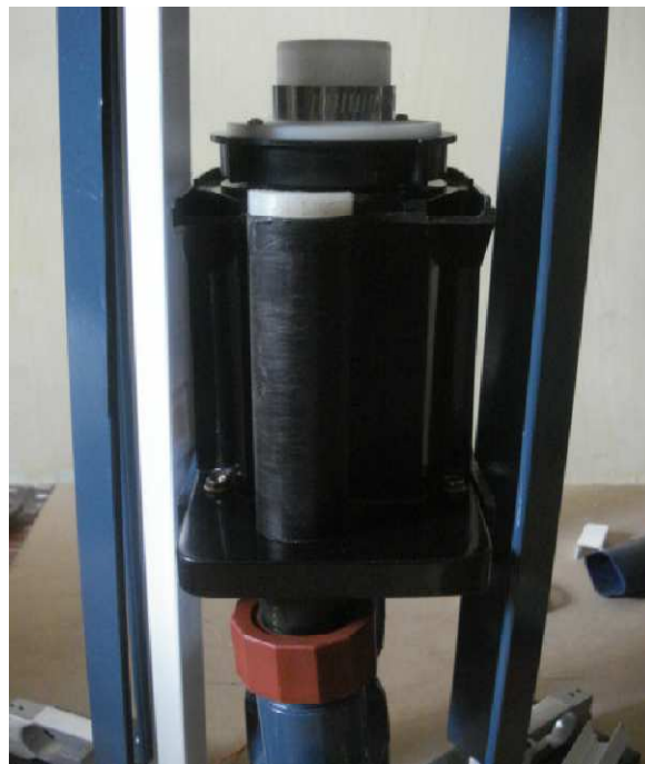
Figura 4.22 Molino de grano adaptado para el nitrato de amonio.
