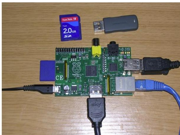
Figura 2.2 Conexiones del Raspberry pi
