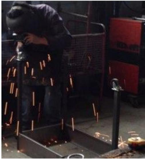
**Figura 4.2.1 soldadura de la parte metálica**
