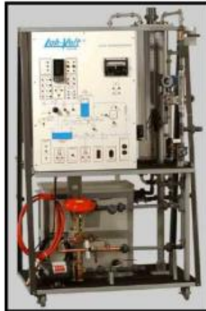
Figura 1.18: Estación de instrumentación del Proceso de Nivel.
