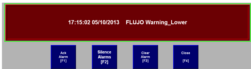
Figura 3.13: Pantalla ALARMA que informa que alarma esa ocurriendo.
