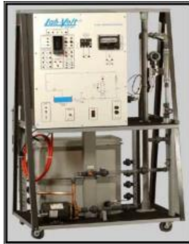
Figura 1.16: Estación de instrumentación del Proceso de Flujo.
