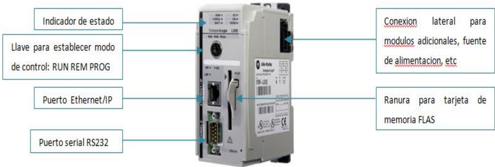
Figura 7. Partes principales del PLC
