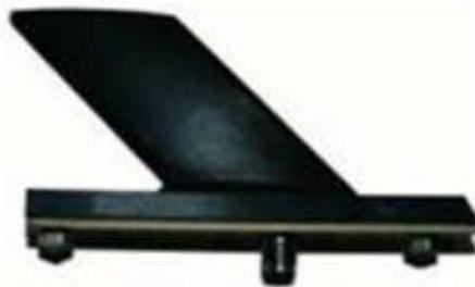
**Figura 1. 3 Antena para telemetría de Fórmula 1**
