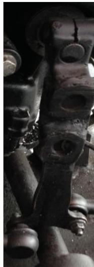
**Figura 3. 1Brazo del eje selector (manivela).**
