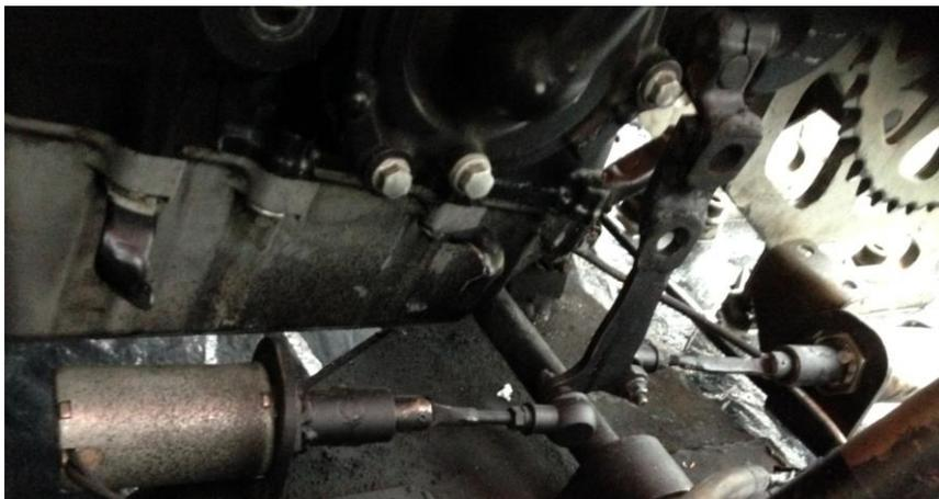
**Figura 4. 6 Electromecanismo en reposo.**
