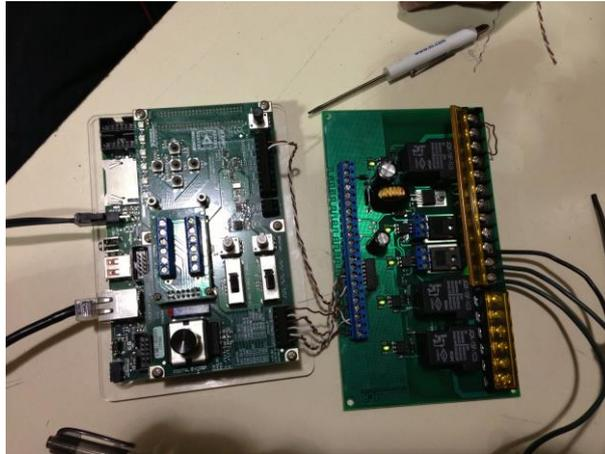
**Figura 4. 2 Conexión de las tarjetas SdRio y circuitos de potencia y control electrónico.**
