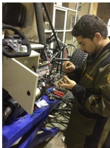
**Figura 3. 10 Ensamblaje de los circuitos eléctricos para el cambio de marchas.**
