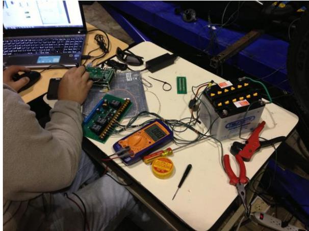
**Figura 4. 3 Comprobación de las entradas, salidas digitales y analógicas de la SdRio.**
