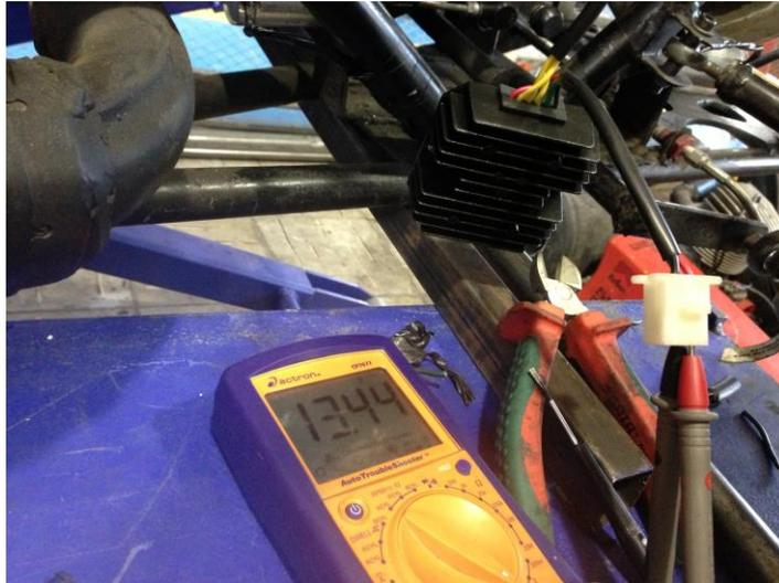
**Figura 3. 14 Voltaje que genera el Rectificador Regulador a 1000 rpm.**
