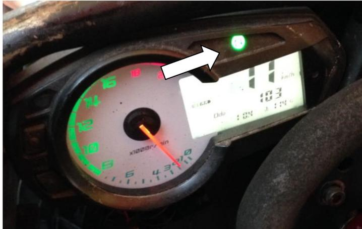
**Figura 4. 5 Panel de instrumentos indicando Neutro.**
