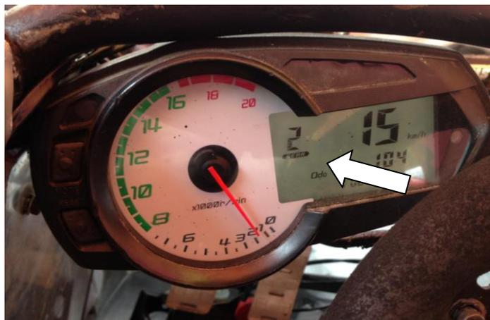
**Figura 4. 12 Panel de instrumentos indicando Segunda.**
