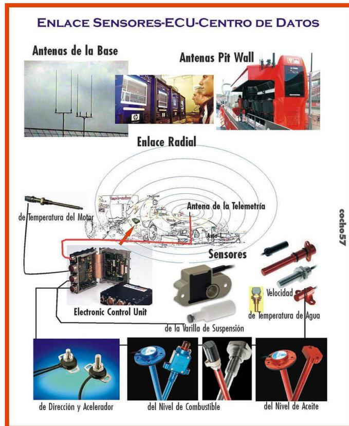
**Figura 2. 26 Ejemplo de Telemetría en la Formula 1].**
