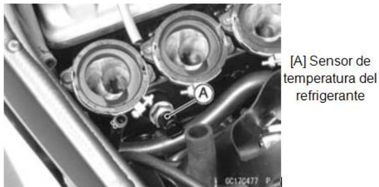
**Figura 2. 19 A Foto del sensor de Temperatura.**
