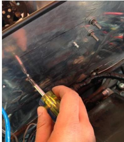
**Figura 3. 21 Se atornilla la base del Router.**
