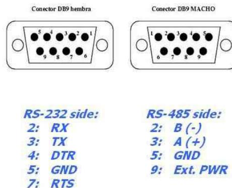
**Figura 1. 11 Conector DB-9 Macho y Hembra.**
