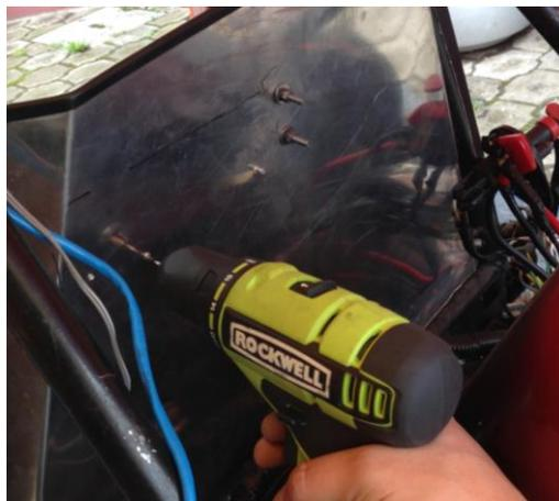
**Figura 3. 20 Se realiza agujeros con el taladro para montar el Router.**
