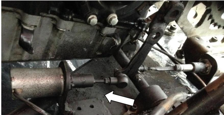
**Figura 4. 11 Electromecanismo subiendo la marcha de primera a segunda.**
