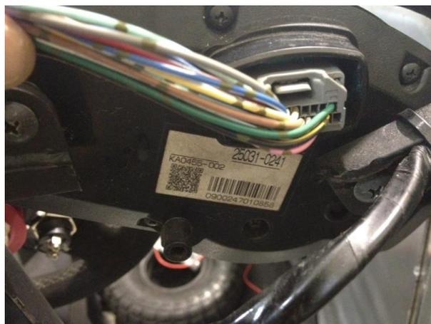
**Figura 3. 17 Conductores de las Señales mostradas en el tablero de instrumentos.**
