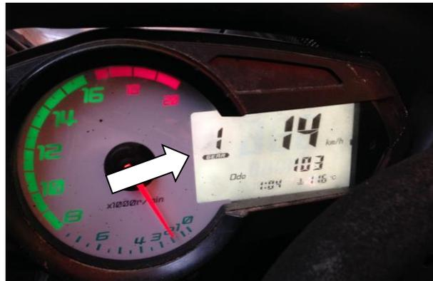
**Figura 4. 9 Panel de instrumentos indicando primera.**
