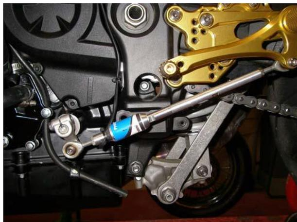
**Figura 1. 35 Electromecanismo del cambio de marchas semiautomático.**
