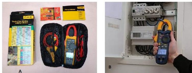
**Figura 4.117.- Pinza amperimétrica (A) medición de voltaje (B)**
