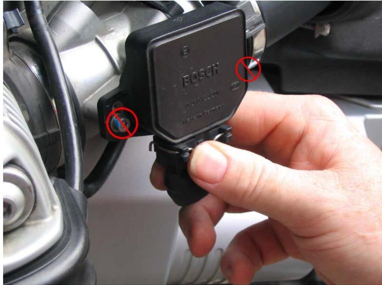
**Figura N° 2.36 Sensor TPS de Chevrolet D MAX**
