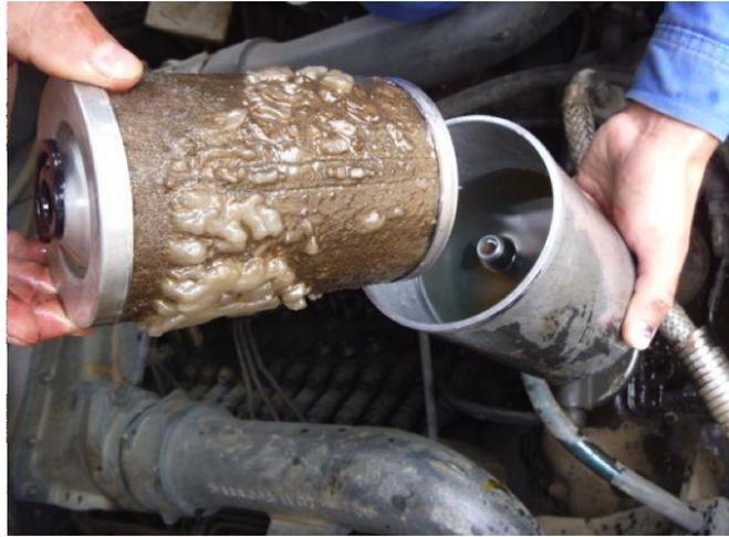
**Figura N° 2.48 Filtro contaminado con bacterias**
