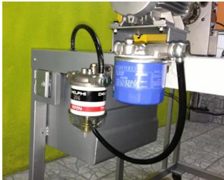
**Figura N° 4.107 Conexión entre el depósito y los filtros de combustible**
