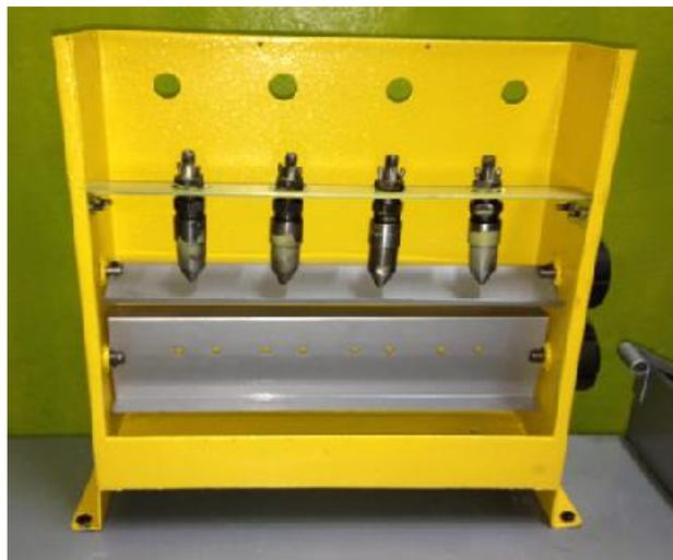
**Figura N° 4.102 Instalación de inyectores y porta probetas**
