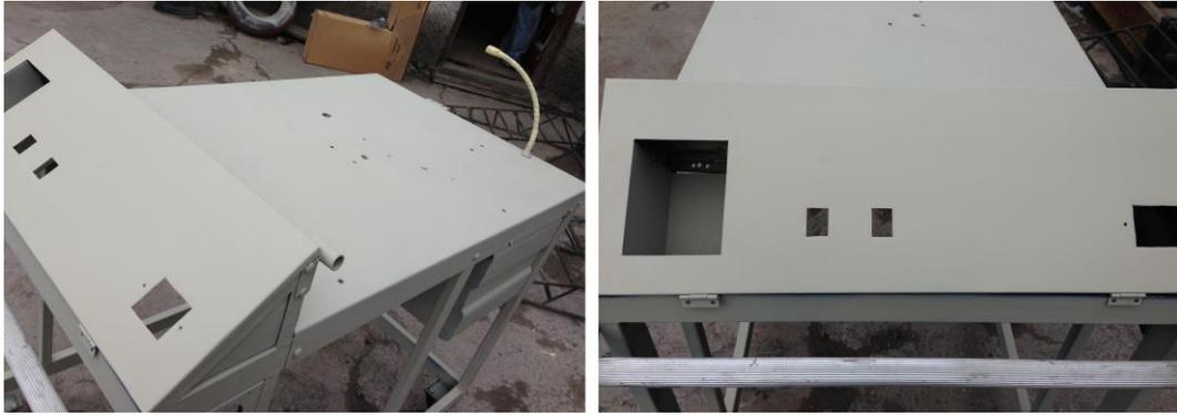
**Figura N° 4.91 Estructura del panel eléctrico**
