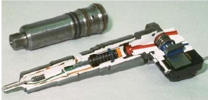
**Figura N° 1.8 Inyector de solenoide**
