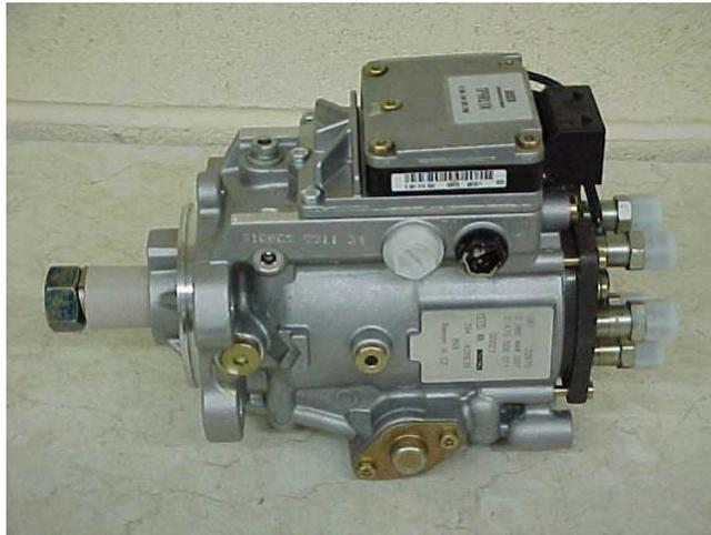
Figura N° 4.96 Bomba de Inyección Electrónica VP44
