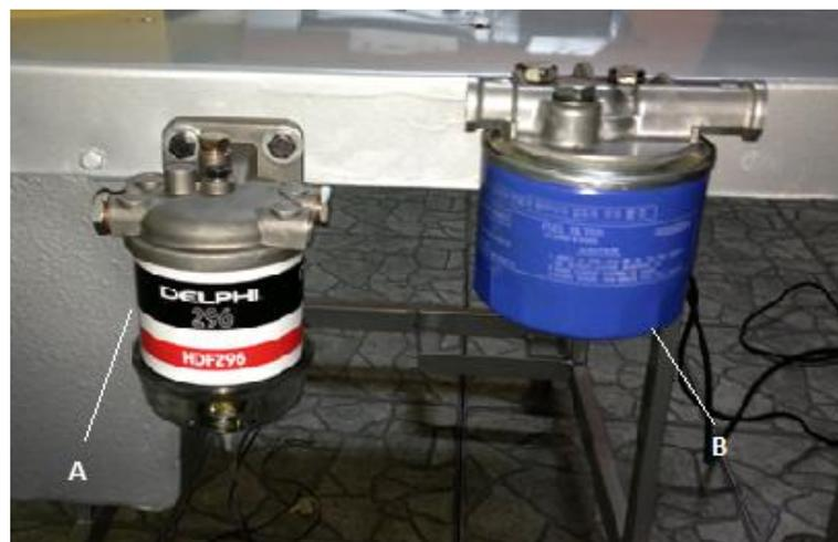
**Figura N° 4.104 Filtro primario (A) filtro secundario (B)**
