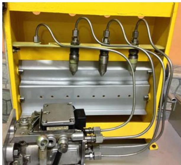
**Figura N° 4.109 Instalación de cañerías de acero entre la bomba VP44 y los inyectores**
