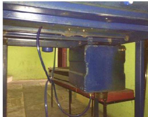
**Figura N° 4.90 Depósito de combustible.**
