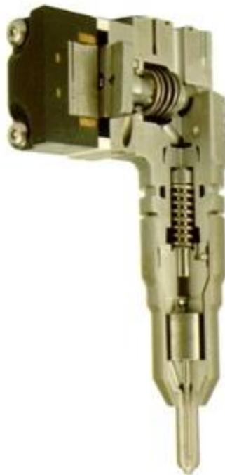
**Figura N° 1.10 Inyector HEUI**
