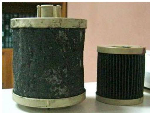
**Figura N° 2.47 Filtro contaminado por agua**
