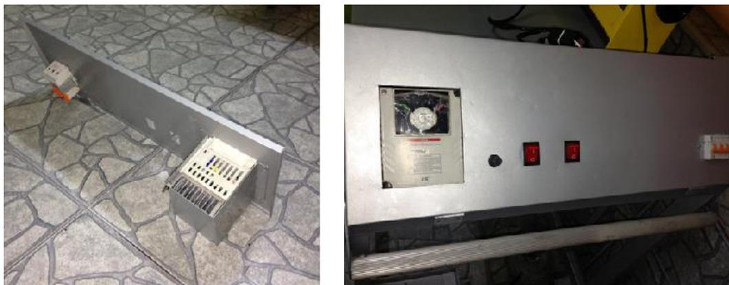
**Figura N° 4.110 Panel frontal eléctrico: variador de frecuencia, interruptores de encendido, break monofásico**
