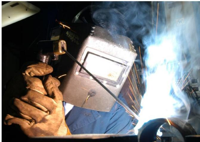
**Figura N° 4.86 Proceso de soldadura al arco eléctrico SMAW (electrodo revestido) utilizado en la construcción de la estructura del banco.**
