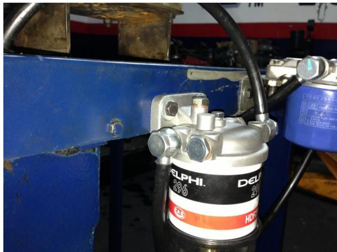
**Figura N° 4.94 Instalación de la base del filtro primario**
