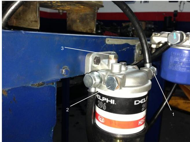
**Figura N° 4.115 Purga del filtro de combustible**
