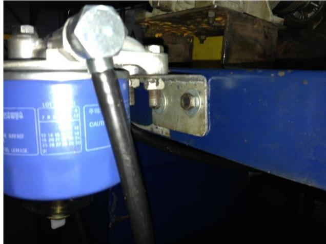
**Figura N° 4.95 Instalación de la base del filtro secundario**
