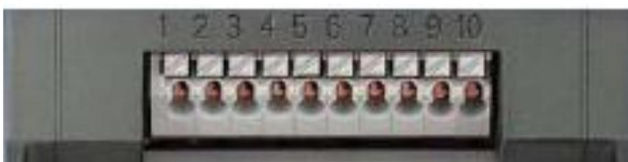
Figura 2. 22 Terminales del variador de velocidad G110
