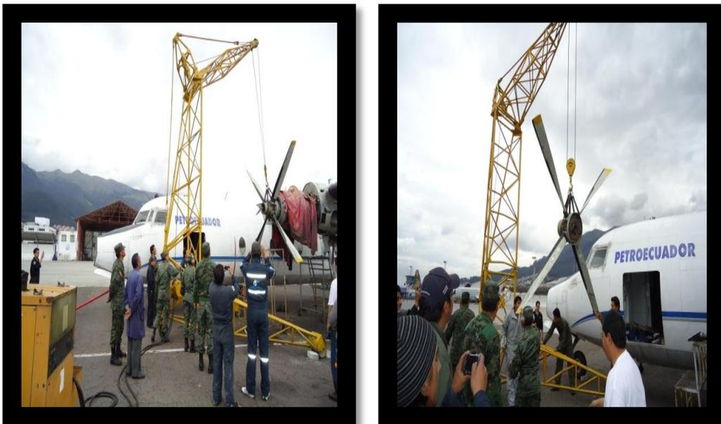
**Figura 3.12:** Desmontaje de las hélices de los motores.
