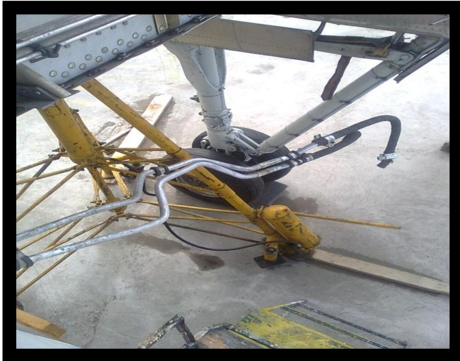
**Figura 3.3:** Desconectando el sistema neumático del tren de aterrizaje.
