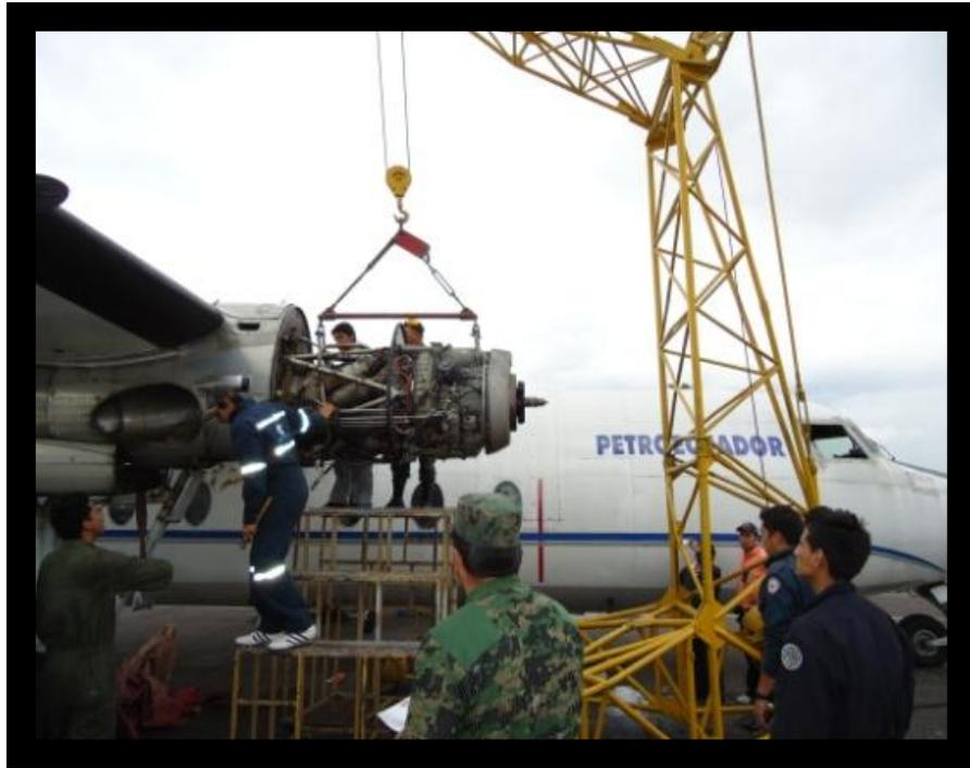
**Figura 3.13:** Desmontaje de los motores y trenes de aterrizaje.
