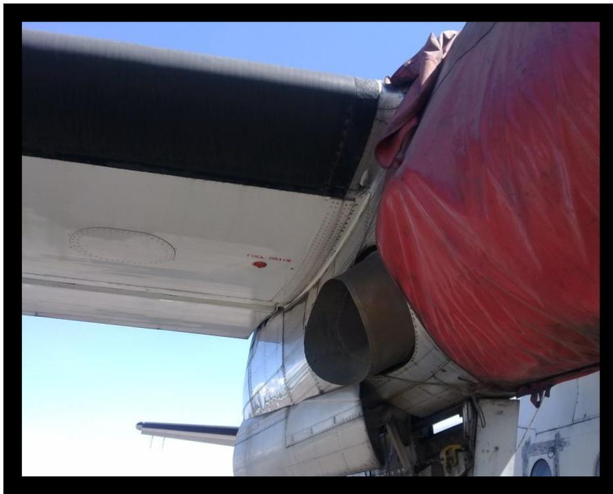
**Figura 3.7:** Punto de drenaje del combustible.
