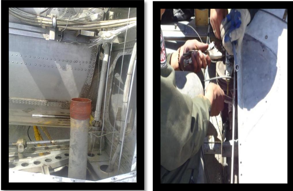
**Figura 3.16:** Desmontaje de los tubos neumáticos.
