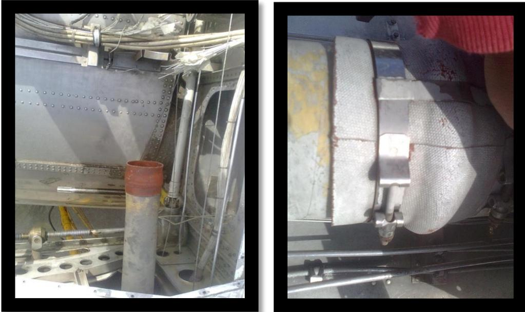
**Figura 3.14:** Desmontaje de la toma de aire primario.
