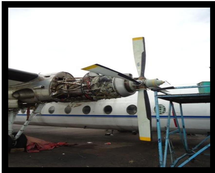
**Figura 3.11:** Desarmado de las capotas de los motores.
