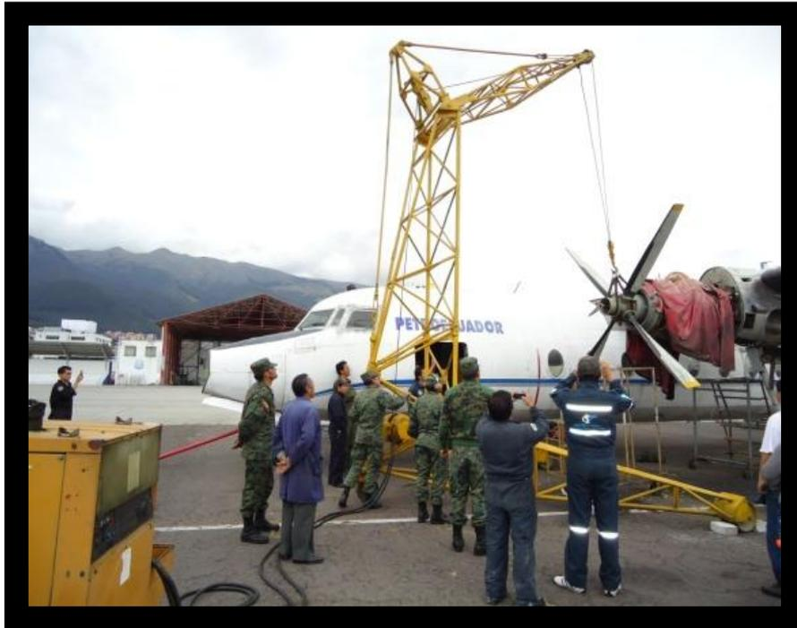
**Figura 3.5:** Equipos y herramientas utilizados en la desconexión.
